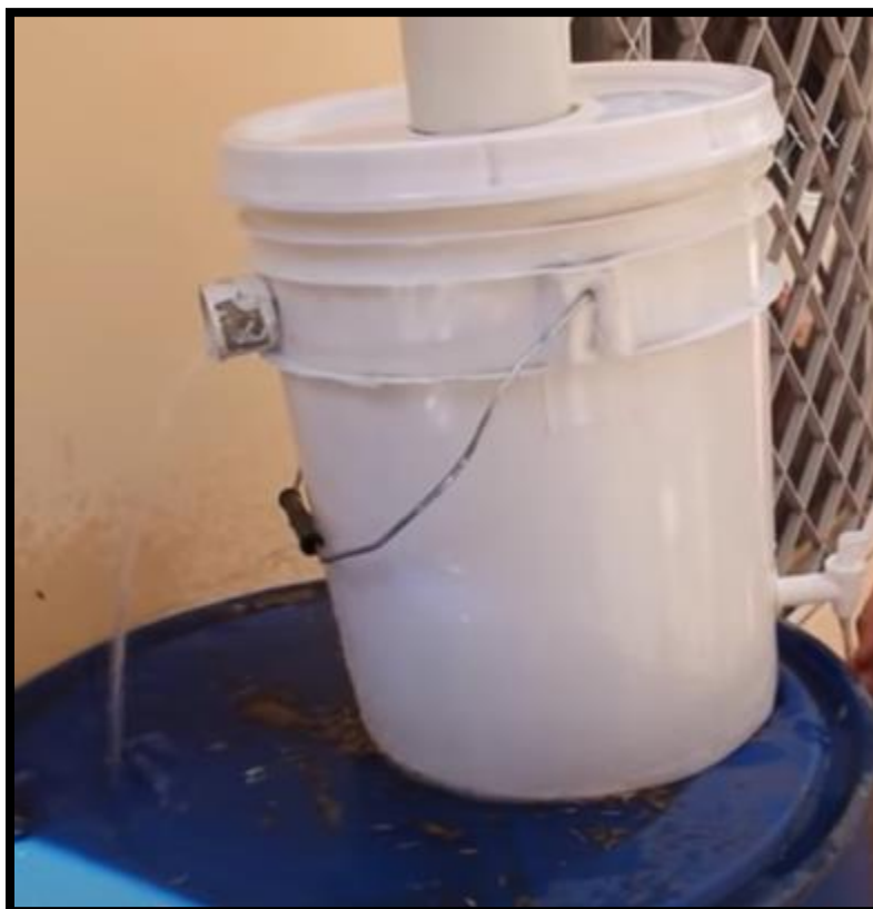
Figura 54 Esquema básico tubería de rebose Fuente: ANAF AE Honduras, https://www.youtube.com/watch?v=r_JEI2EKEUY
