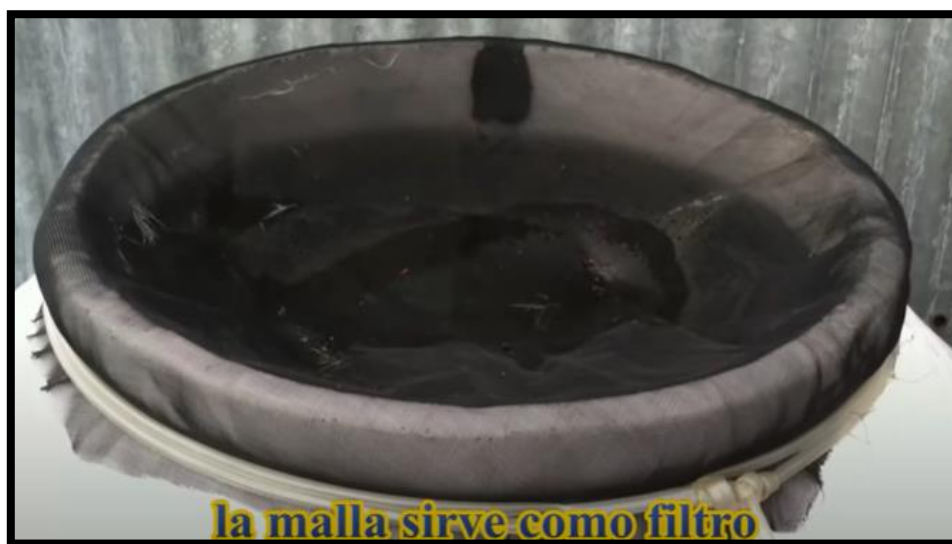
Figura 47 Ejemplo Malla en tanque de almacenamiento https://www.youtube.com/watch?v=4bv4xPEXJsQ Fuente: El autor
