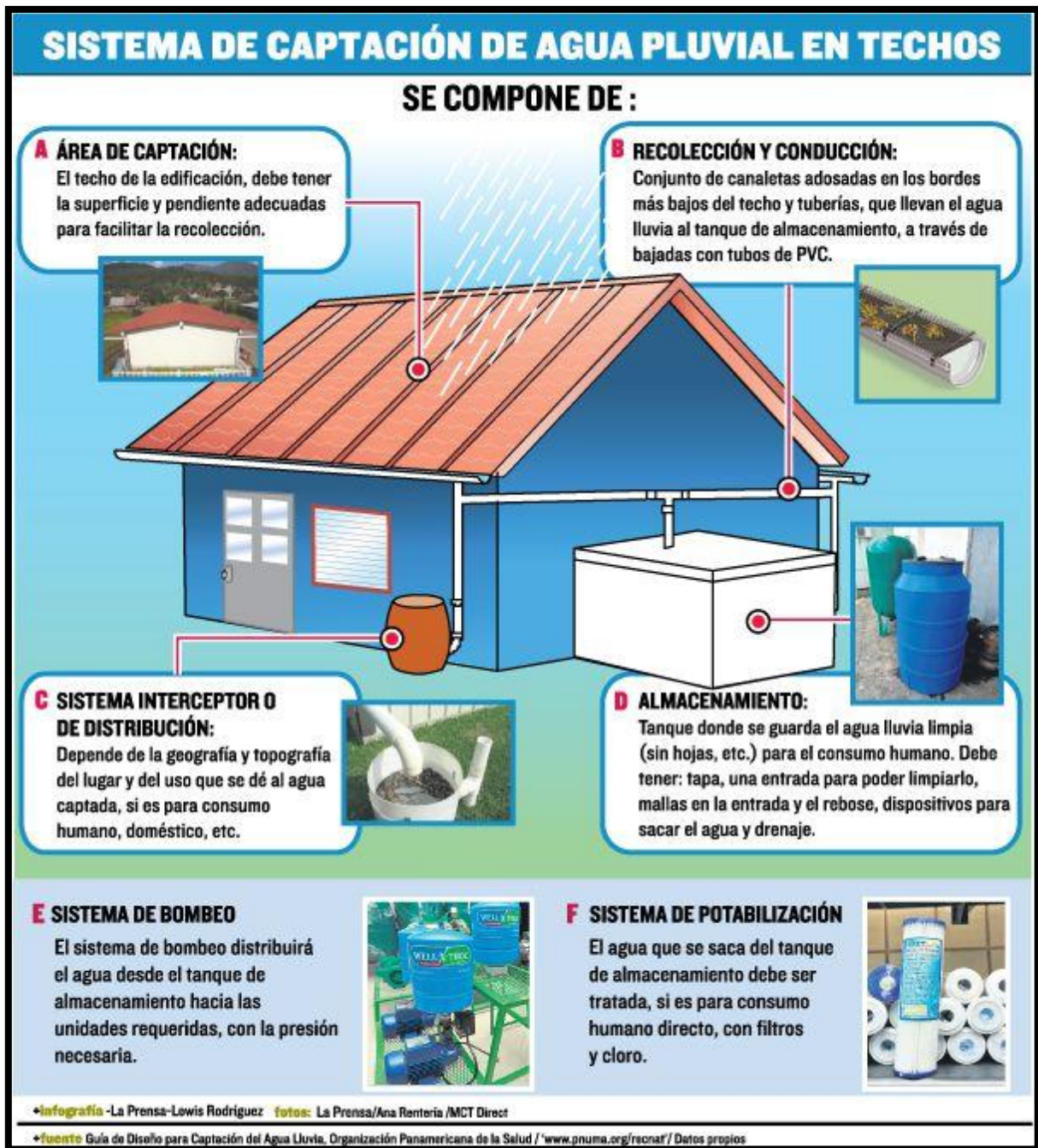
Figura 25 Sistema de captación de agua lluvia en techos Fuente: PRENSA.COM ¿Cómo cosechar agua lluvia? https://www.prensa.com/cultura/Cosechar-agua-lluvia_0_2913458660.html
