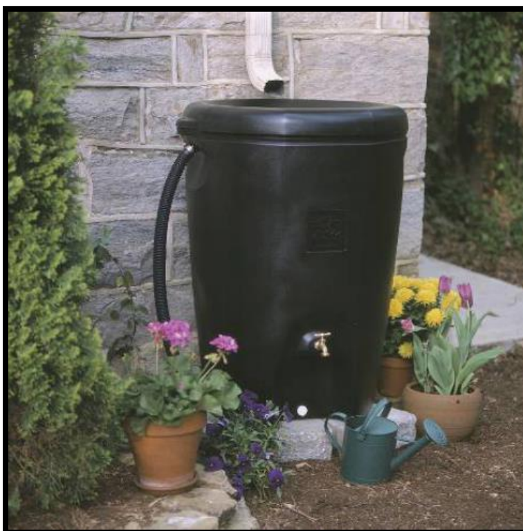
Figura 23 Tanque de recepción de primeras aguas
