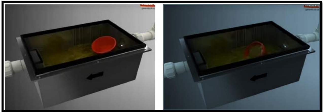
Figura 172. Mantenimiento a la trampa de grasas
