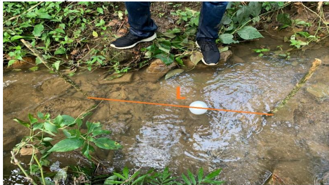
Figura 5. Aforo del Afluente Hoyo Frio.
