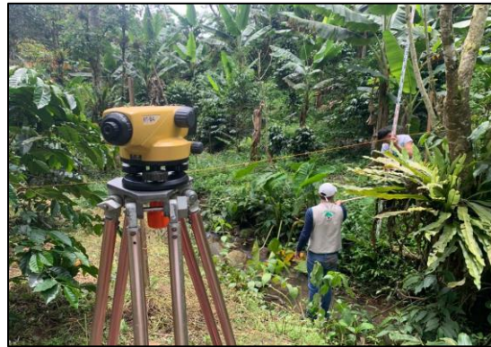
(b) Toma de alturas con jalones y mira taquimétrica.
