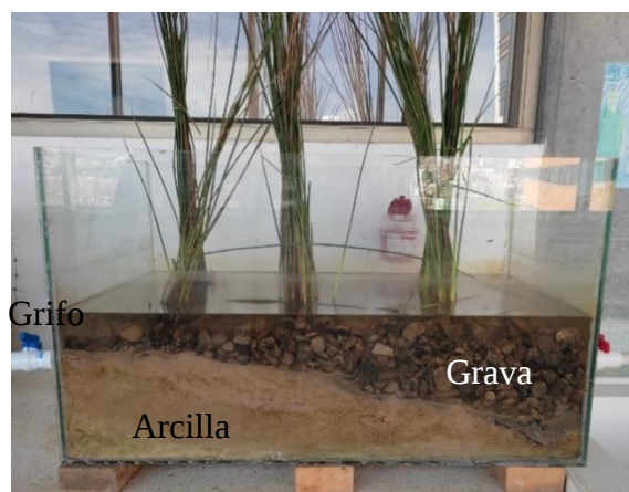
Ilustración 4. Humedal subsuperficial de flujo vertical.
