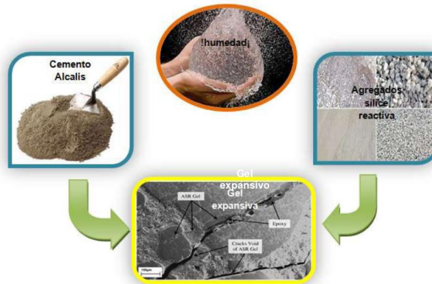
Figura No.1: Esquema del proceso de la RAA
