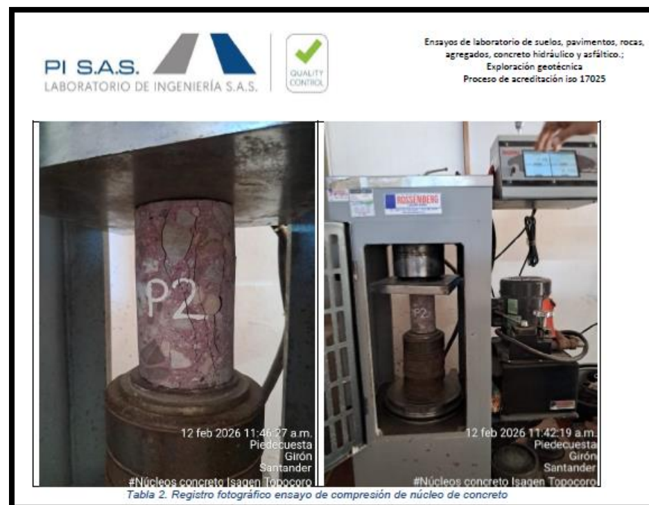
Fotografía No.19 – Ensayo a la Compresión de la muestra P2 – Fuente Informe Laboratorio.
