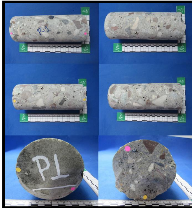
Fotografía No.20: Muestra N1, mostrando vistas laterales, la parte superior y parte inferior del núcleo. Los puntos naranja y rosado muestran la orientación de los cortes – Fuente Informe Laboratorio.
