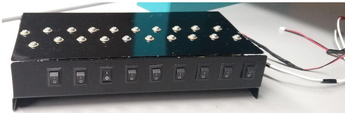
FIGURA 10: Banco de resistencias de 1.2\Omega a 11\Omega . Fuente: Autor
