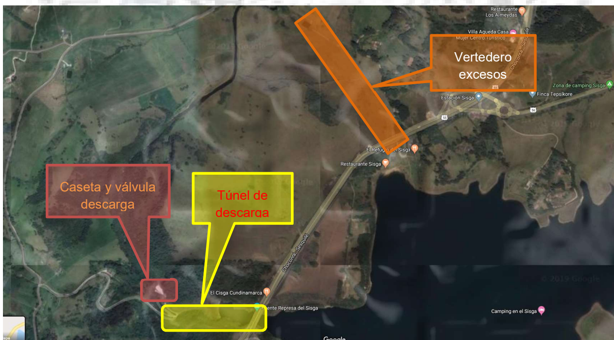
Ilustración 5. Planta general de obras Embalse del Sisga.
