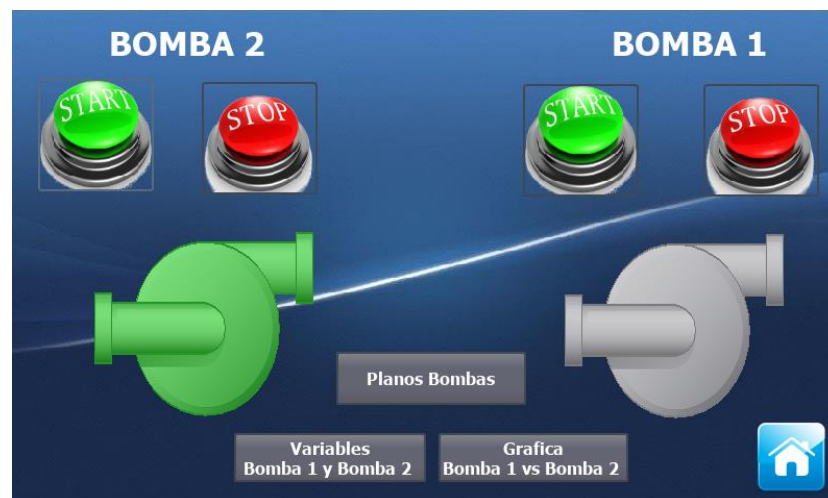
Figura 65 Pantalla para activar y desactivar las bombas.
