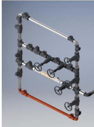
Figura 20 Primer diseño del banco de bombas.
