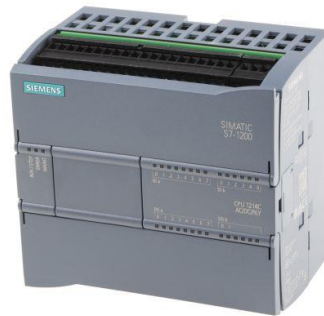
Figura 34 PLC Siemens S7 1200
