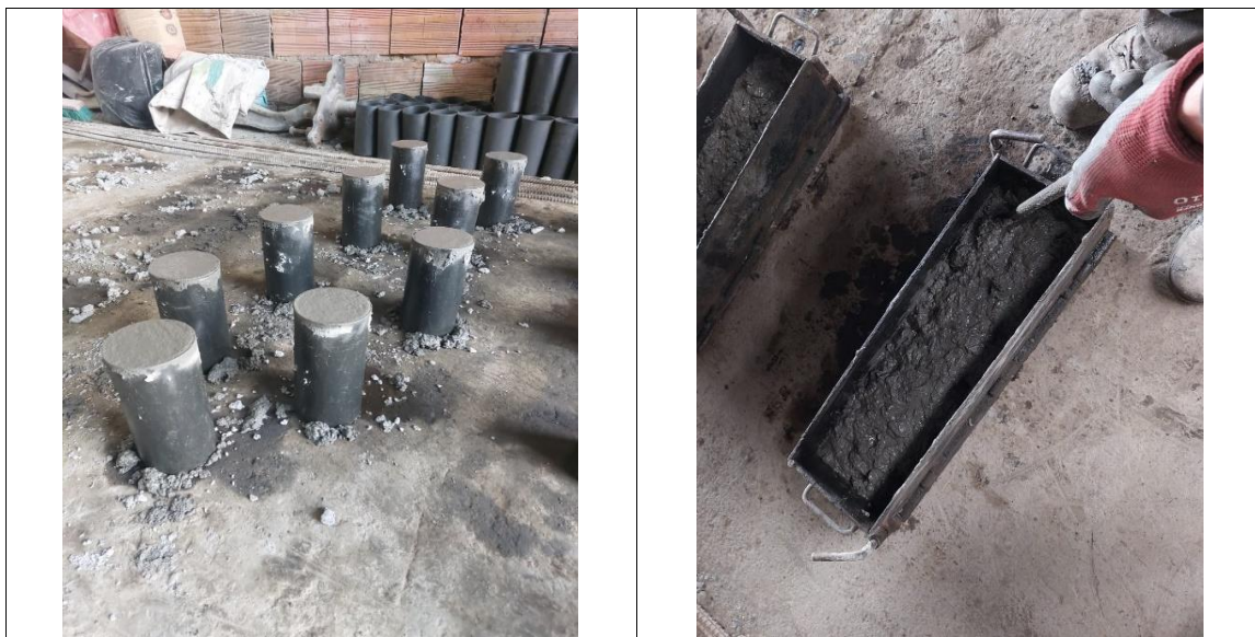
Figura 28. Elaboración de cilindros y vigas
