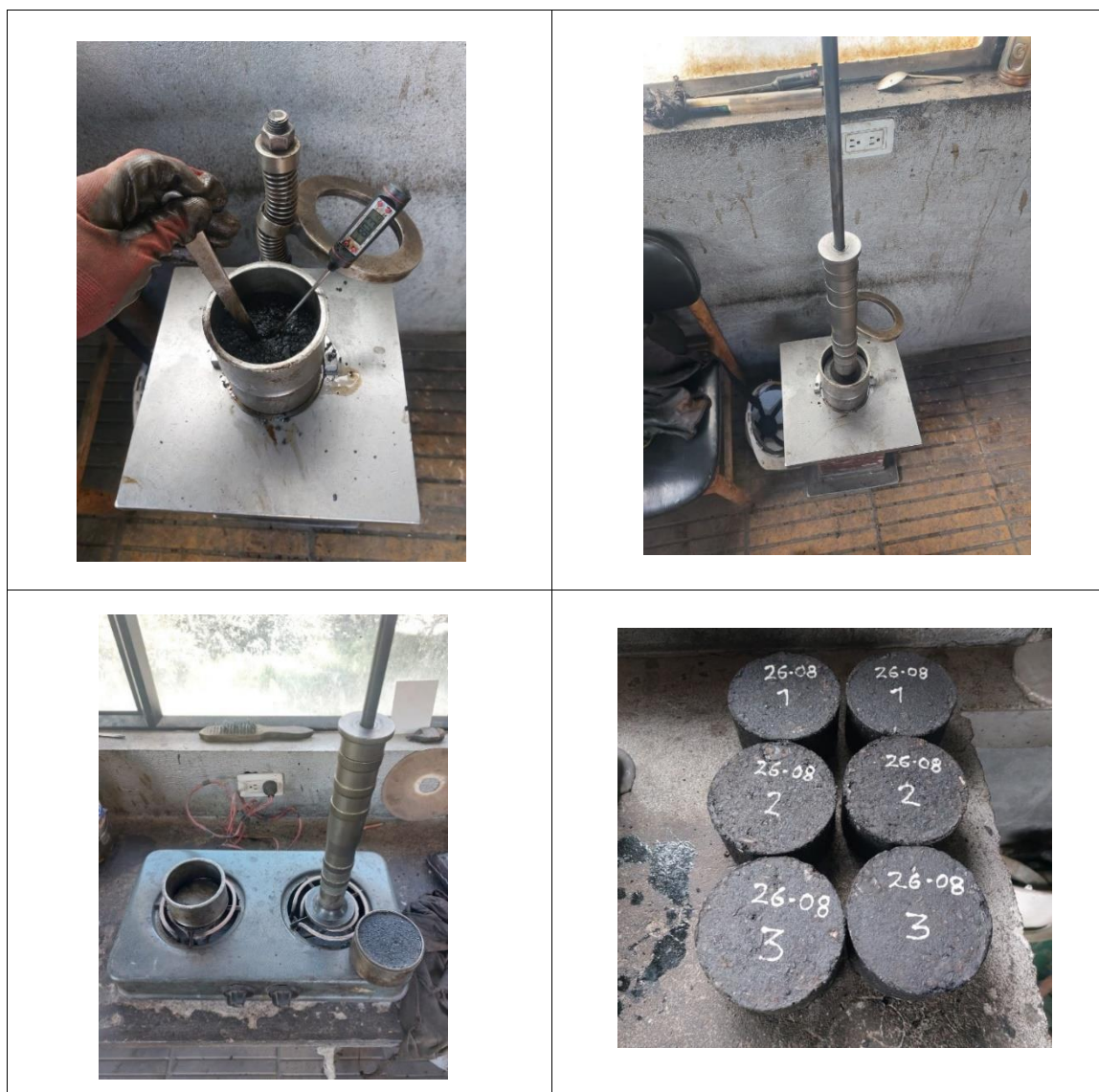
Figura 35. Realización briquetas de asfalto
