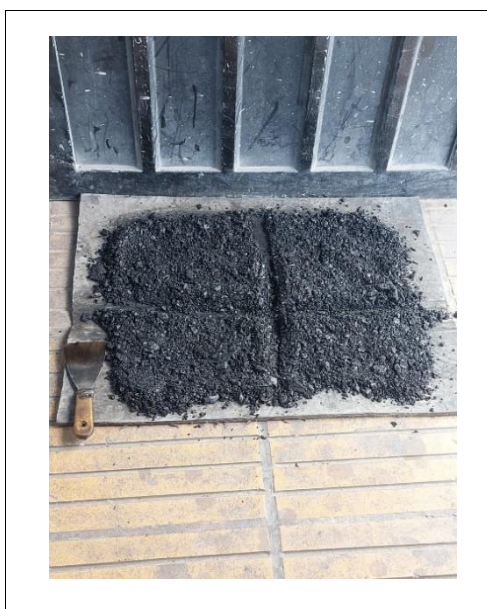
Figura 37. Cuarteo de muestra asfáltica para RICE
