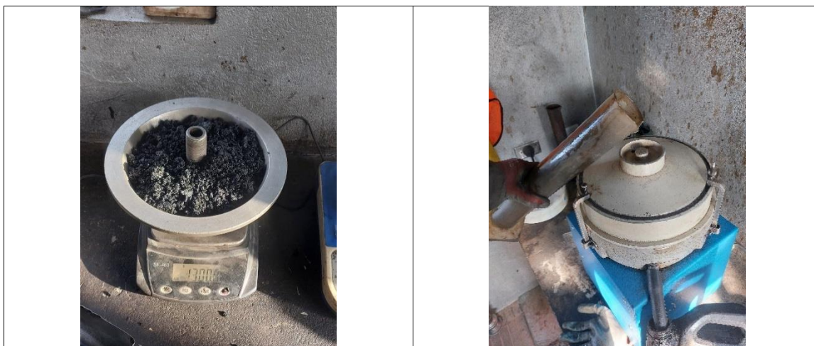
Figura 34. Lavado de muestras asfálticas
