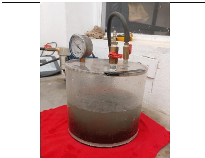
Figura 22. Ensayo de vacíos MDC19 en matraz
