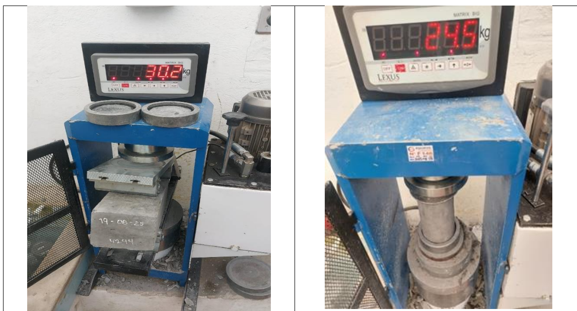
Figura 23. Falla de vigas a flexión y cilindros a compresión
