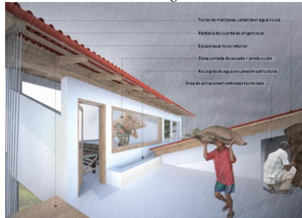
Figura 15. Detalle del sistema de recolección de agua
