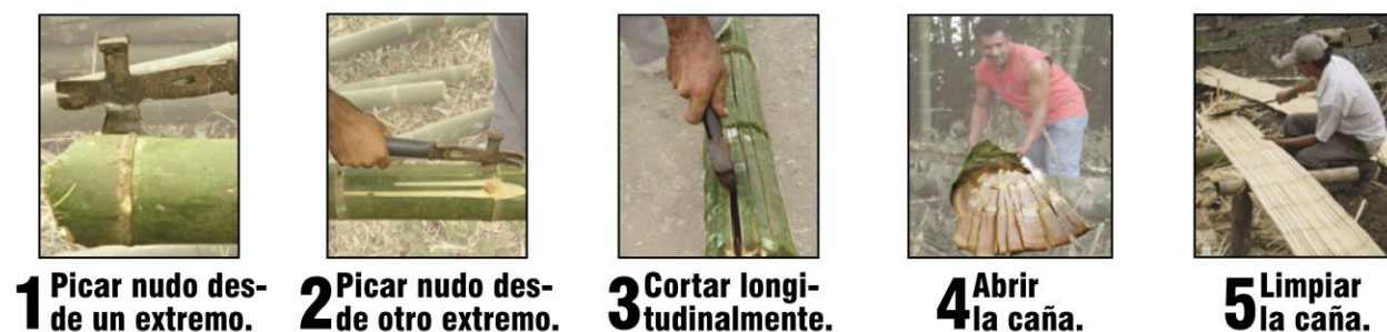
Figura 39. Tipo de cortes / caña picada.
