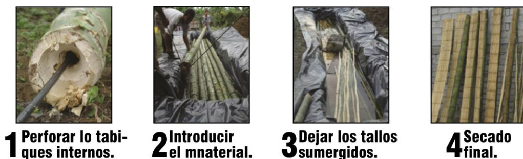
Figura 38. Materia prima / Preservación y secado químico de la caña.
