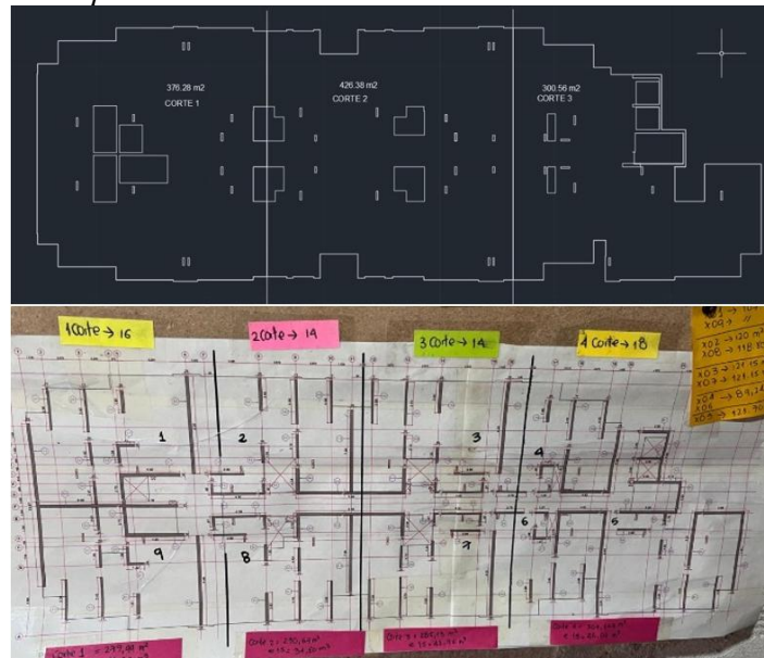
Figura 15. Corte adicional en placa de torre 1.
