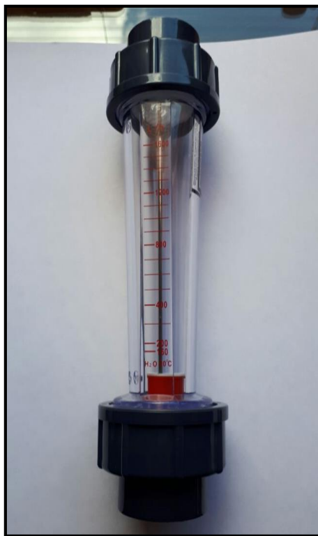
Figura 3-22. Caudalímetro o rotámetro. Fuente: Autores.
