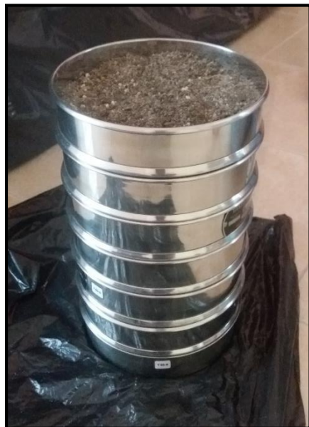
Figura 3-4. Proceso de tamizaje. Fuente: Autores
