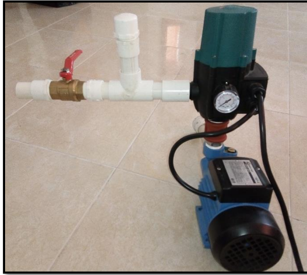
Figura 3-21. Válvula de bola de bronce y sistema de purga. Fuente: Autores.
