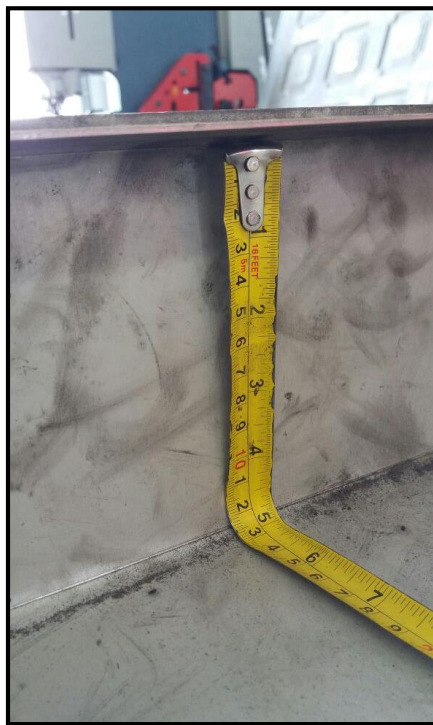
Figura 3-31 Verificación de medida del alto del tanque de arena. Fuente: Autores.
