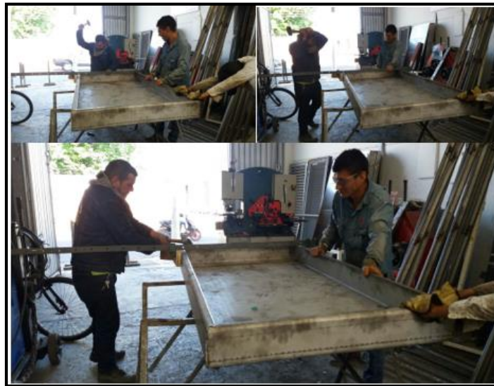
Figura 3-35 Juntando las uniones o esquinas del tanque de arena. Fuente: Autores.
