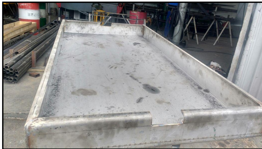
Figura 3-37 Cortes tanque de arena. Fuente: Autores
