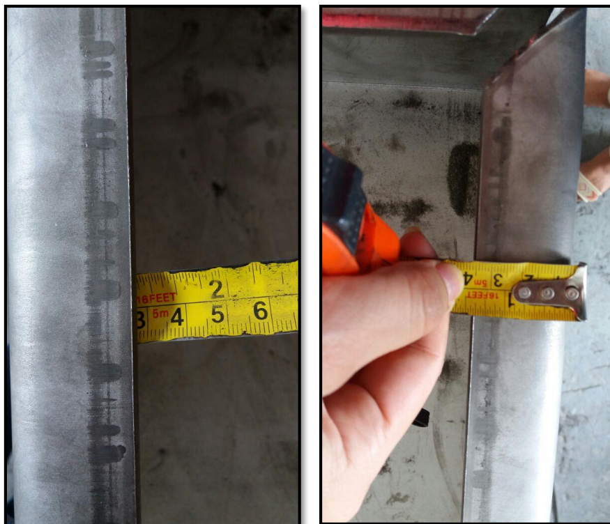
Figura 3-30 Verificación de medida de pestaña del tanque de arena. Fuente: Autores.
