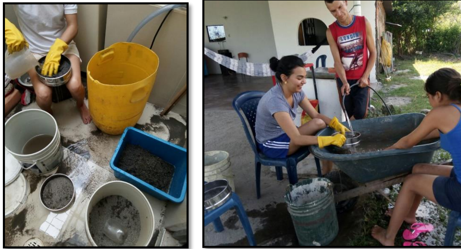
Figura 3-24. Limpieza del material granular. Fuente: Autores.
