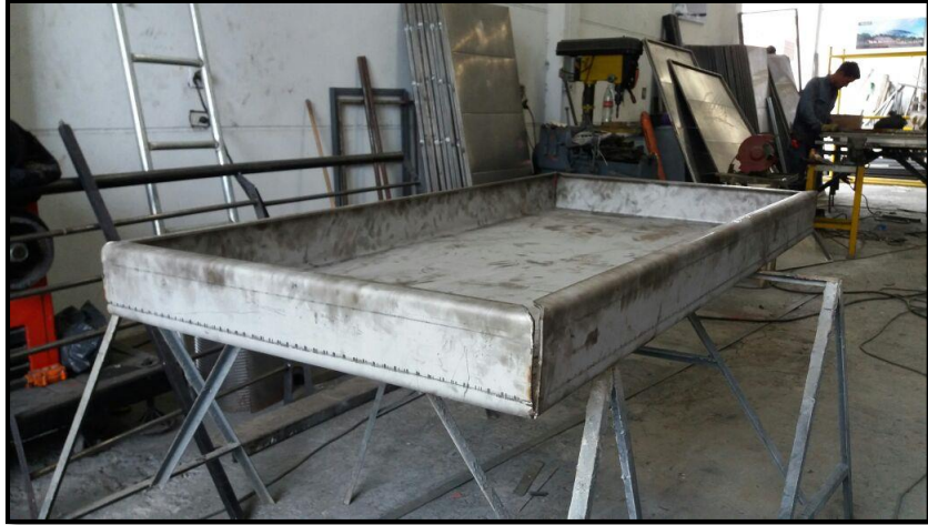
Figura 3-28 Lámina de acero cortada y doblada. Fuente: Autores
