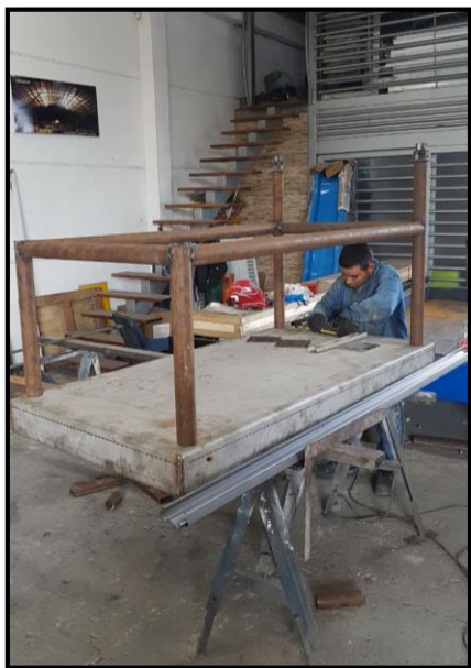
Figura 3-38 Armadura de estructura de soporte. Fuente: Autores
