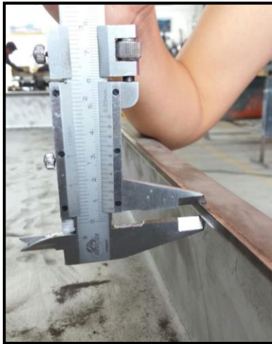
Figura 3-29 Verificación de medida del espesor de la lámina de acero inoxidable. Fuente: Autores.
