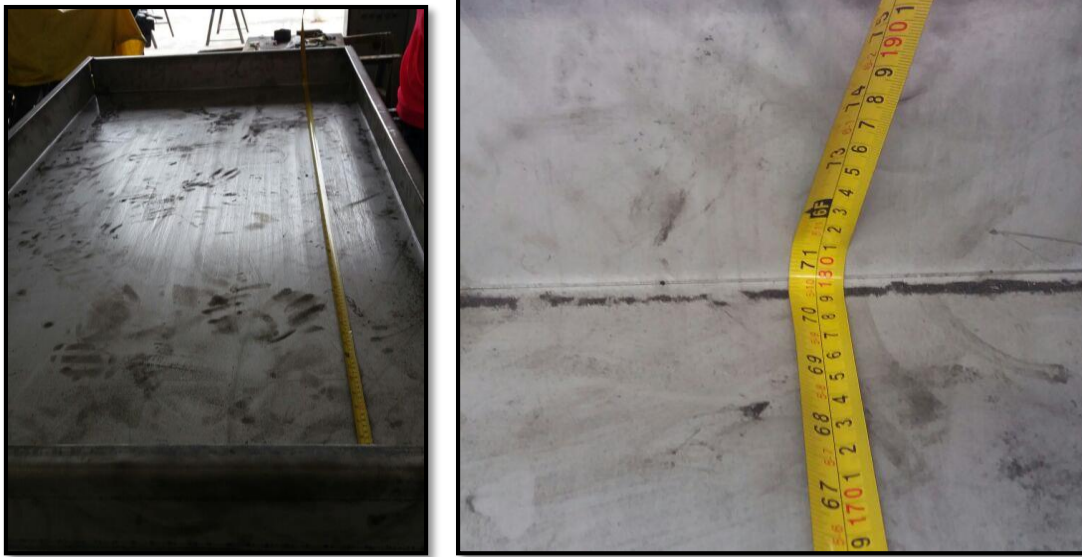
Figura 3-32 Verificación de medida del largo del tanque de arena. Fuente: Autores.
