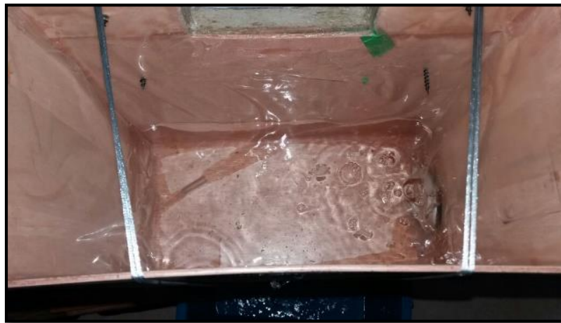
Figura 3-15. Prueba del vertedero rectangular. Fuente: Autores.
