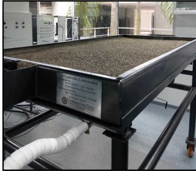
Figura 4-4. Adecuación del lecho rugoso. Fuente: Autores
