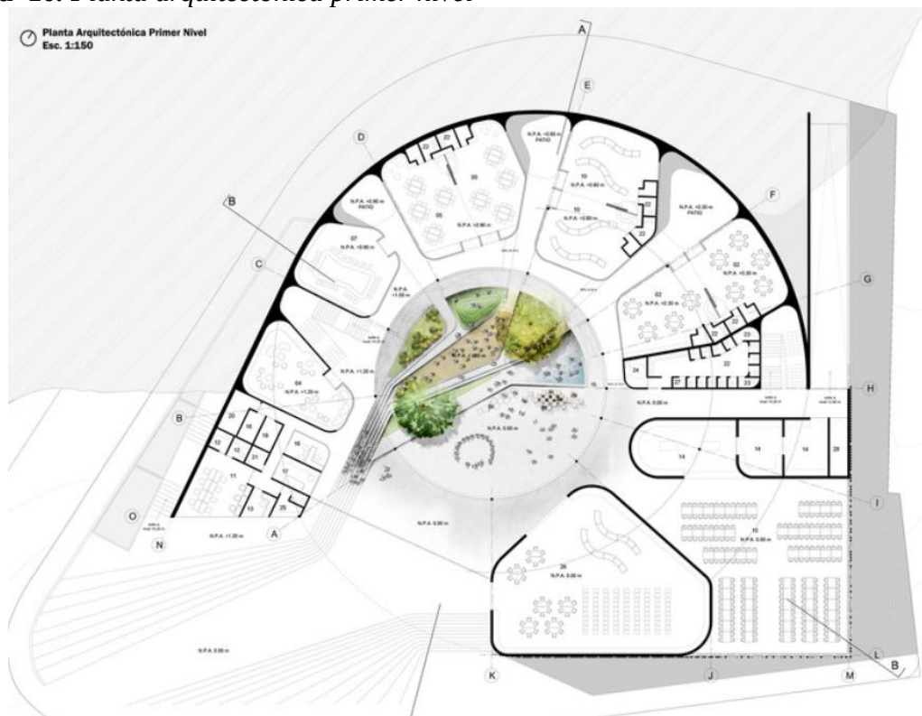
Figura 10. Planta arquitectónica primer nivel
