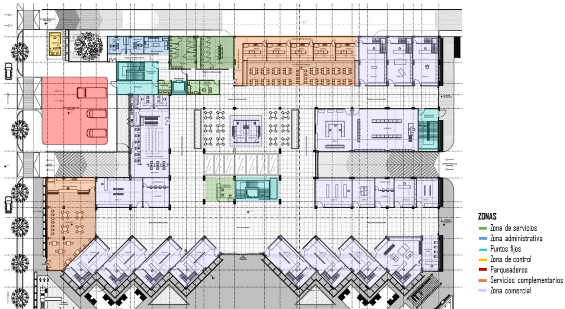
Figura 56. Zonificación primer piso.
