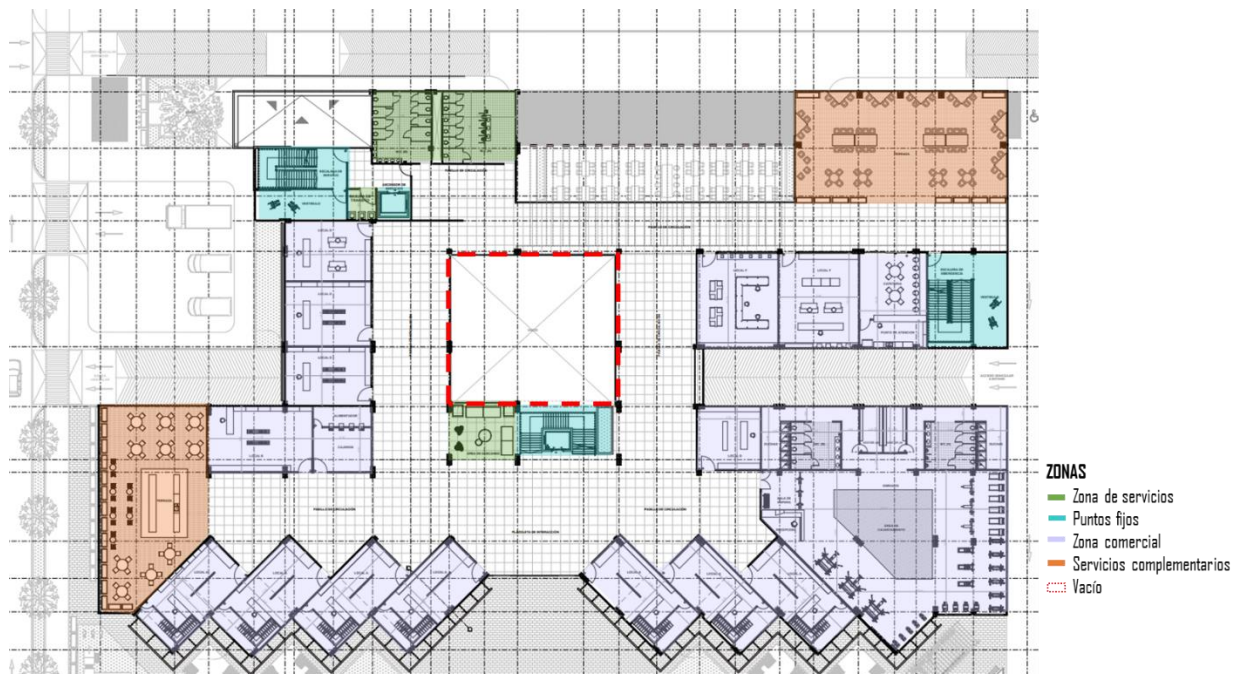
Figura 57. Zonificación segundo piso
