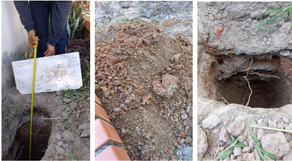
Figura 12. Apique 1 - Auscultación de suelo cerca columneta 4A
