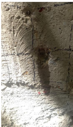
Figura 9. Aplicación prueba con fenolftaleína Columneta 2H
