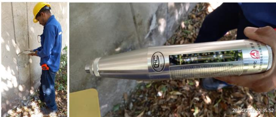
Figura 6. Ejecución Pruebas de esclerometría Columneta Eje 3H
