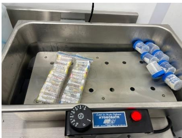
Figura 8. Almacenamiento de las muestras posterior a la obturación en Hygrobath® (instrumento para almacenar especímenes o dientes a temperatura y humedad controlada).
