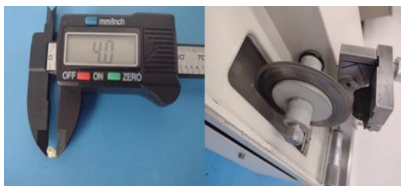
Figura 9. Estandarización y corte con maquina QUEHELER ISOMED 1000
