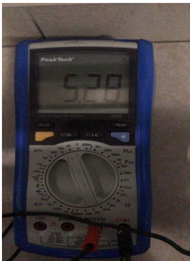
Imagen 53 Voltaje de la Batería Fuente: Autores
