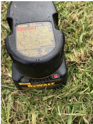
Imagen 49 Prueba de batería cargando Taladro
