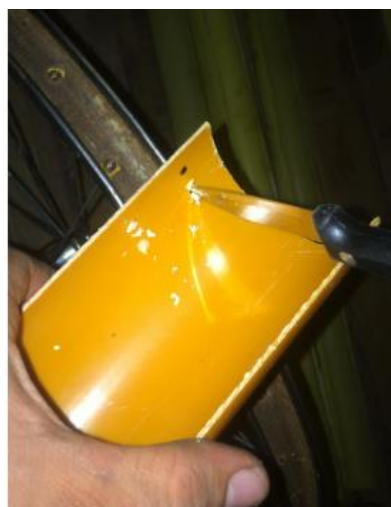
Imagen 18 Corte de puntos en el tubo de PVC Fuente: Autores.
