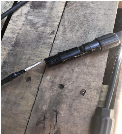
Imagen 44 Conectores MC4, Cable con terminales Fuente: Autores
