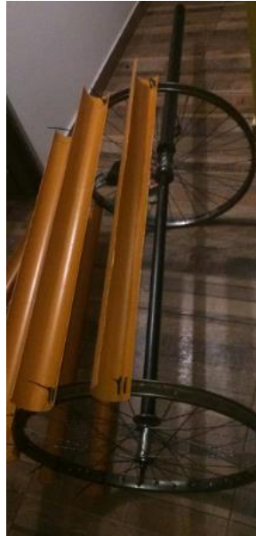
Imagen 23 Instalación de tubos cortados en rines con abrazaderas. Fuente: Autores
