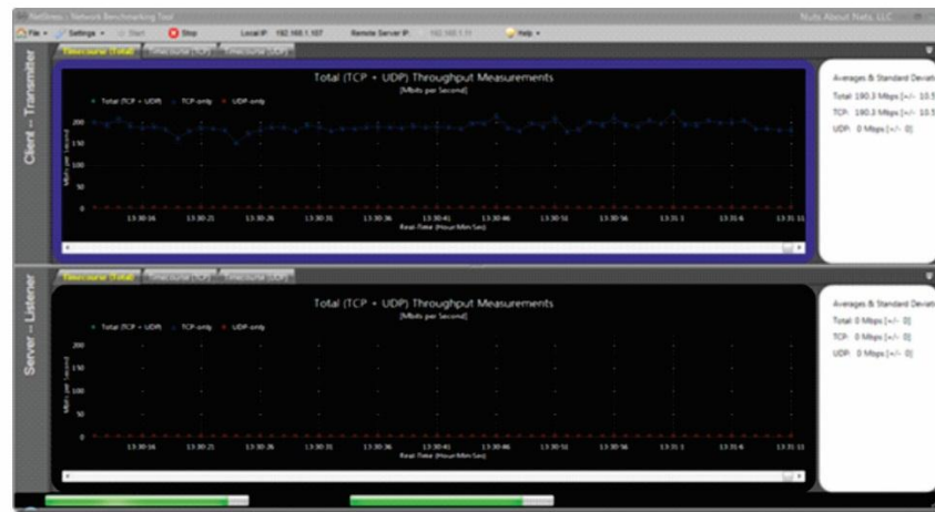
Figura 5.20 Netstress se maneja con controles gráficos intuitivos, en el panel aparecen dos gráficas, una superior muestra las medidas en el cliente y la inferior muestra las medidas en el servidor.
