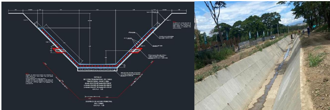
Figura 1. Ejemplo de canales de lluvias
