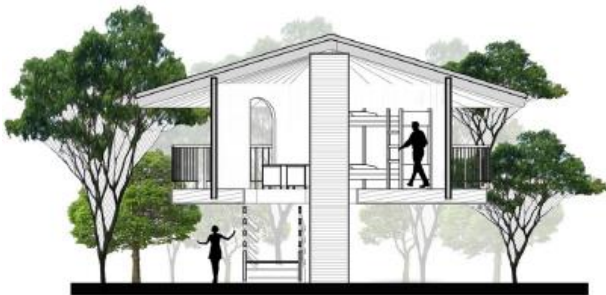
PLANO 15 Corte longitudinal Módulo glamping Palafito
