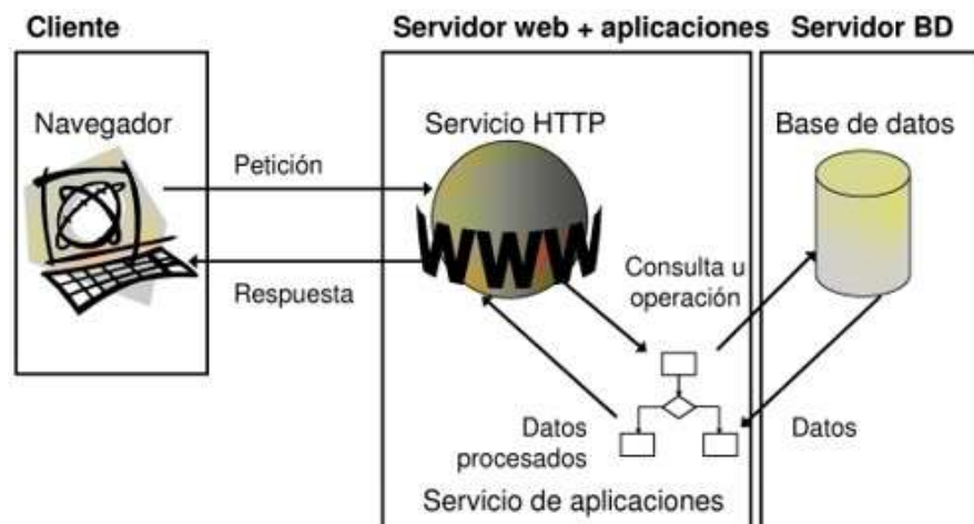
Figura 4. Arquitectura de las aplicaciones web: separación de servidor de datos, con servicio de aplicaciones. Fuente:[22]
