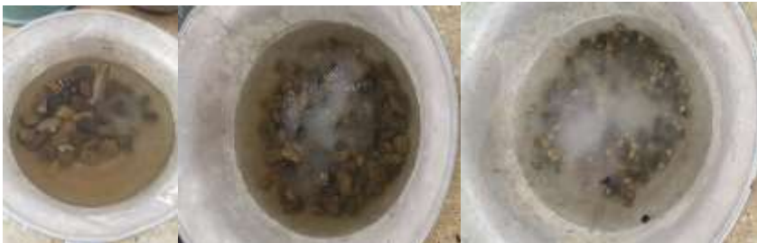
Ilustración 45. Agregado grueso sumergido en sulfato
