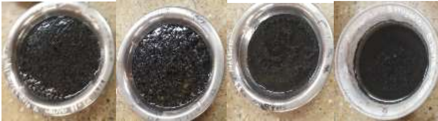
Ilustración 44. Arena de río sumergida en sulfatos
