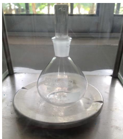
Figura 9. Picnómetro con el cual se llevó a cabo la medición de la densidad de las muestras, por Miguel Méndez, 2018.
