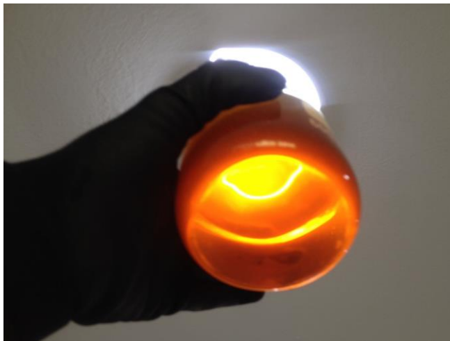
Figura 8. Proceso de medición del color del aceite vegetal mediante el sometimiento de la muestra a un cuerpo de luz conocido como método de Louvibond, por Miguel Méndez, 2018.
