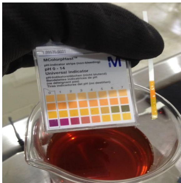
Figura 7. Tiras de tornasol con las que se llevó a cabo la medición del PH del AVU, Miguel Méndez, 2018.
