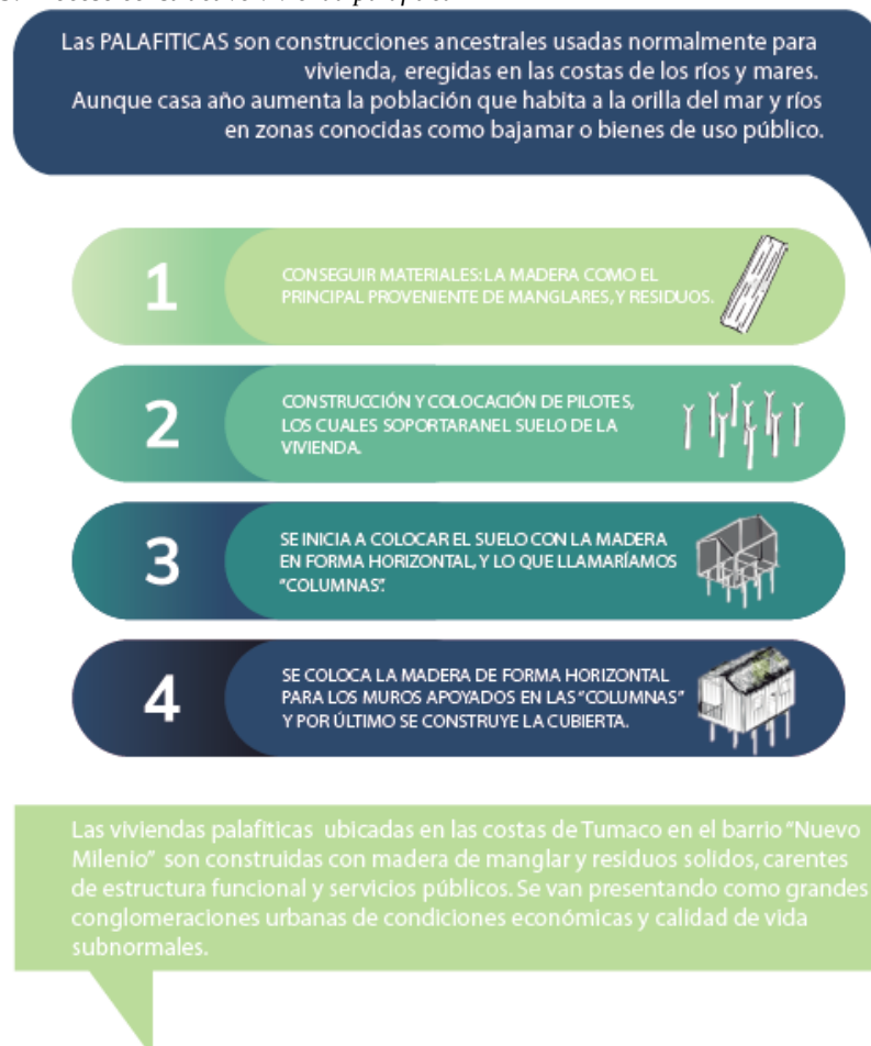
Gráfica 13: Proceso constructivo vivienda palafítica
