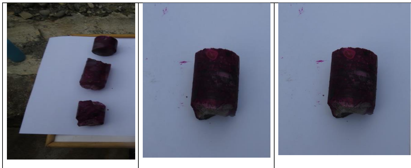
Figura 7. Resultado de ensayo de carbonatación.
