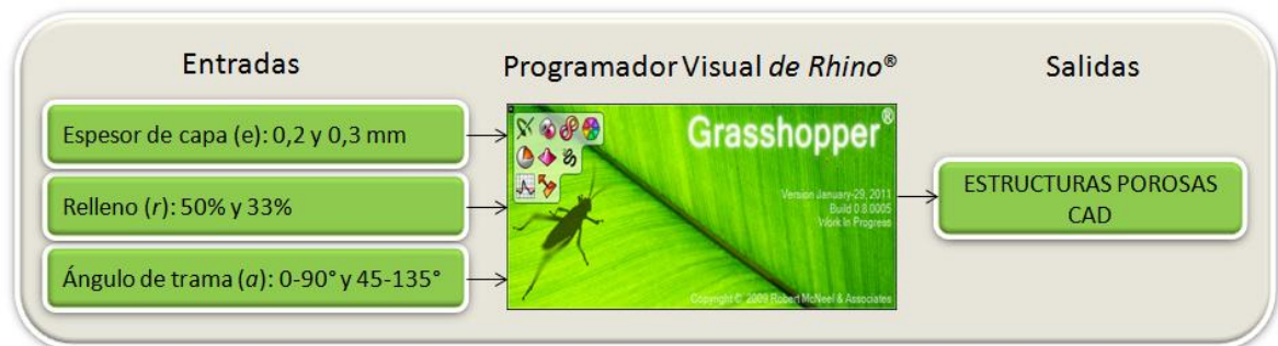
Figura 28. Esquema del proceso de diseño para las estructuras porosas
