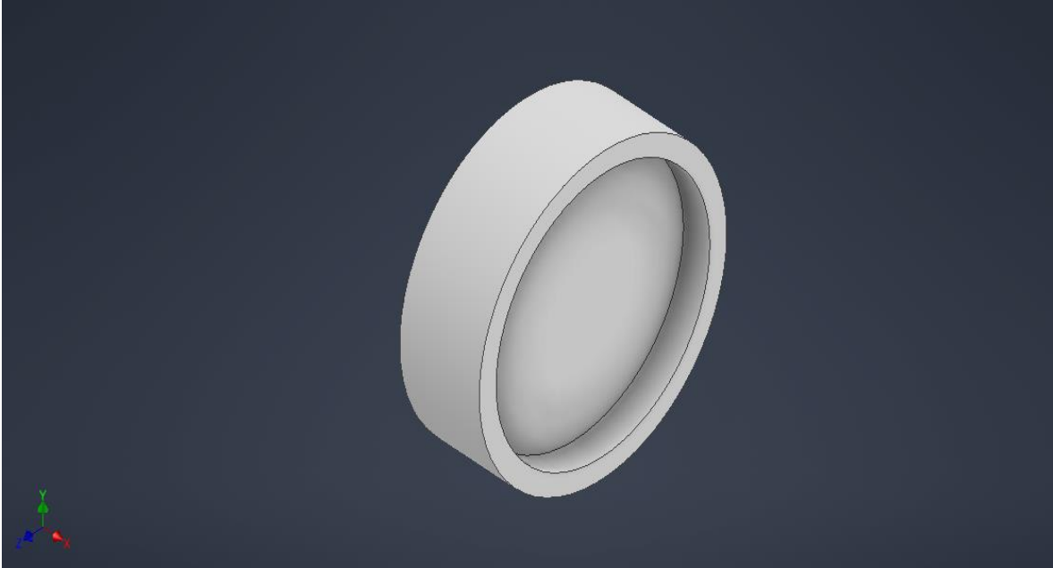
Figura 61. Diseño CAD del soporte aislante para el imán de pulso.
