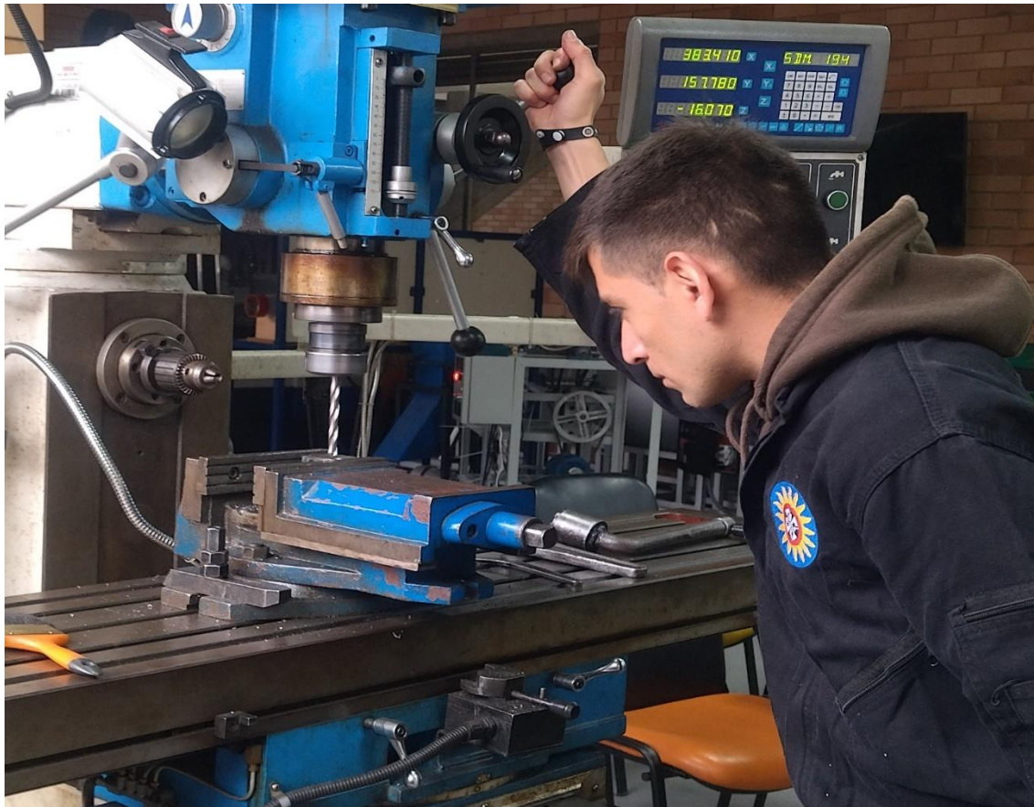
Figura 14. Proceso de fabricación de agujeros para los soportes mediante el uso de fresadora.
