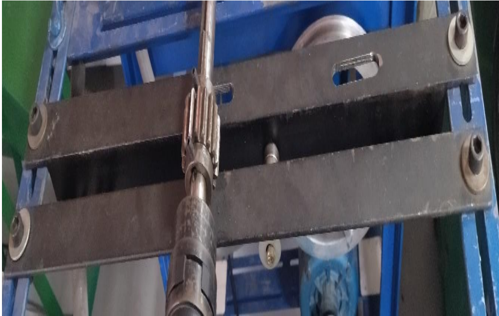
Figura 22. Sistema de engrane - cremallera a rediseñar.
