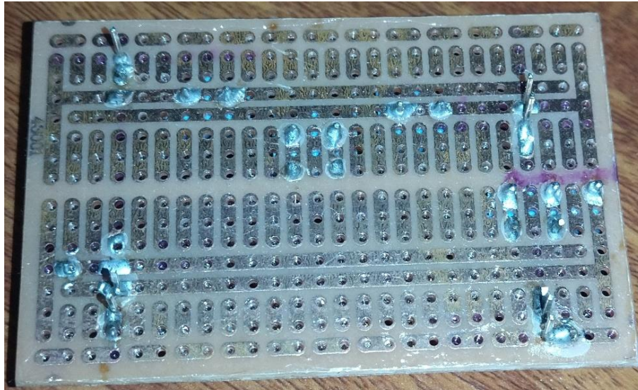
Figura 52. Soldaduras de estaño para las pistas de cobre, esmalte
