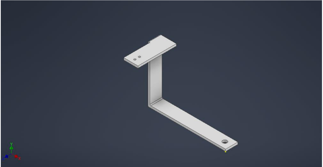
Figura 63. Soporte del sensor efecto hall para la etapa del motor.
