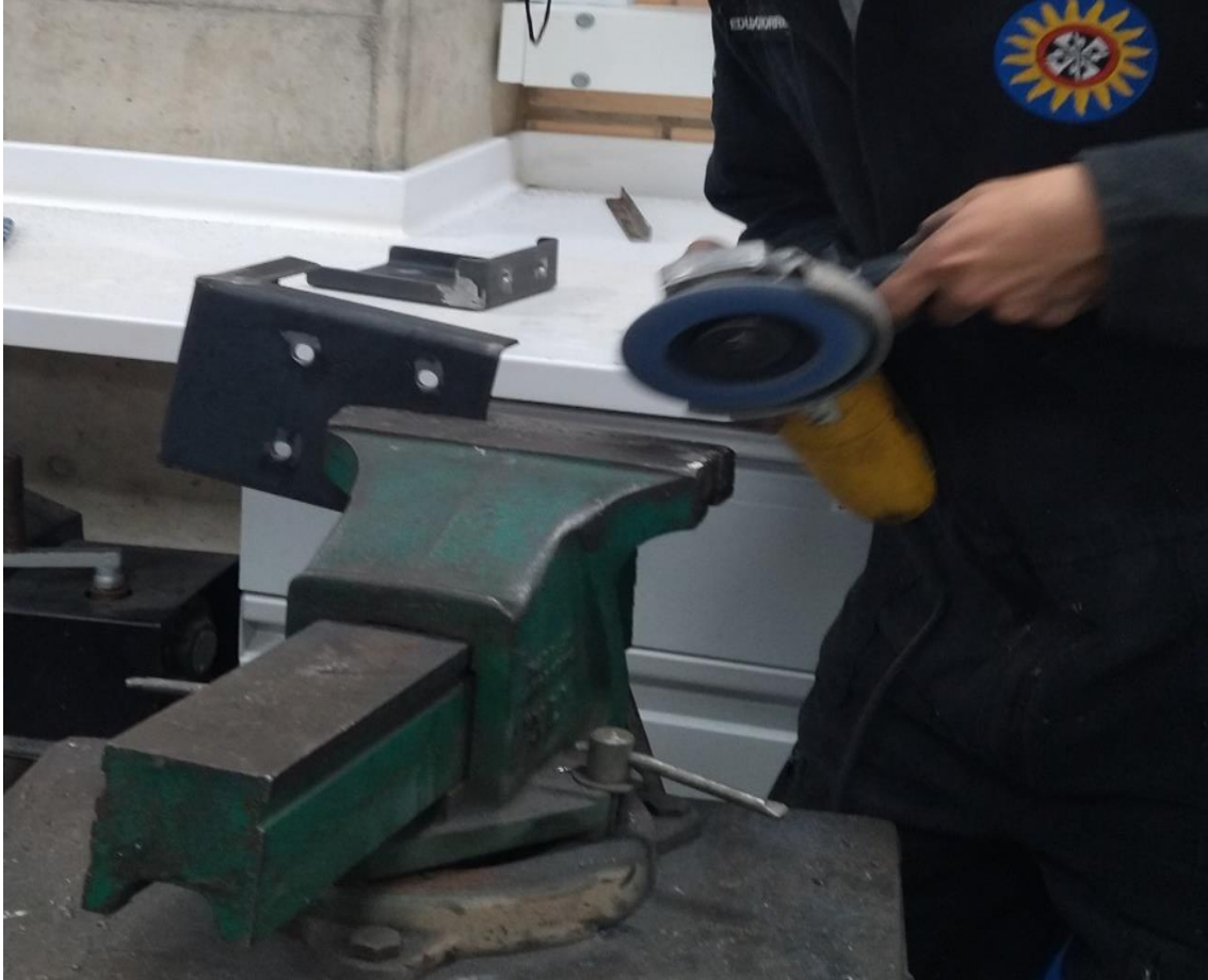
Figura 13. Procesamiento de las láminas dobladas.
