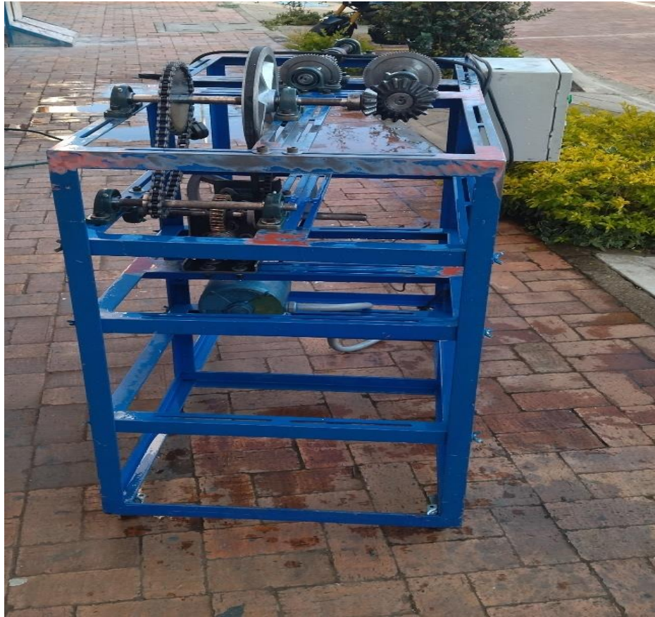
Figura 28. Lavado general de la máquina con agua y jabón, este proceso permite que la pintura logre un mejor acabado.
