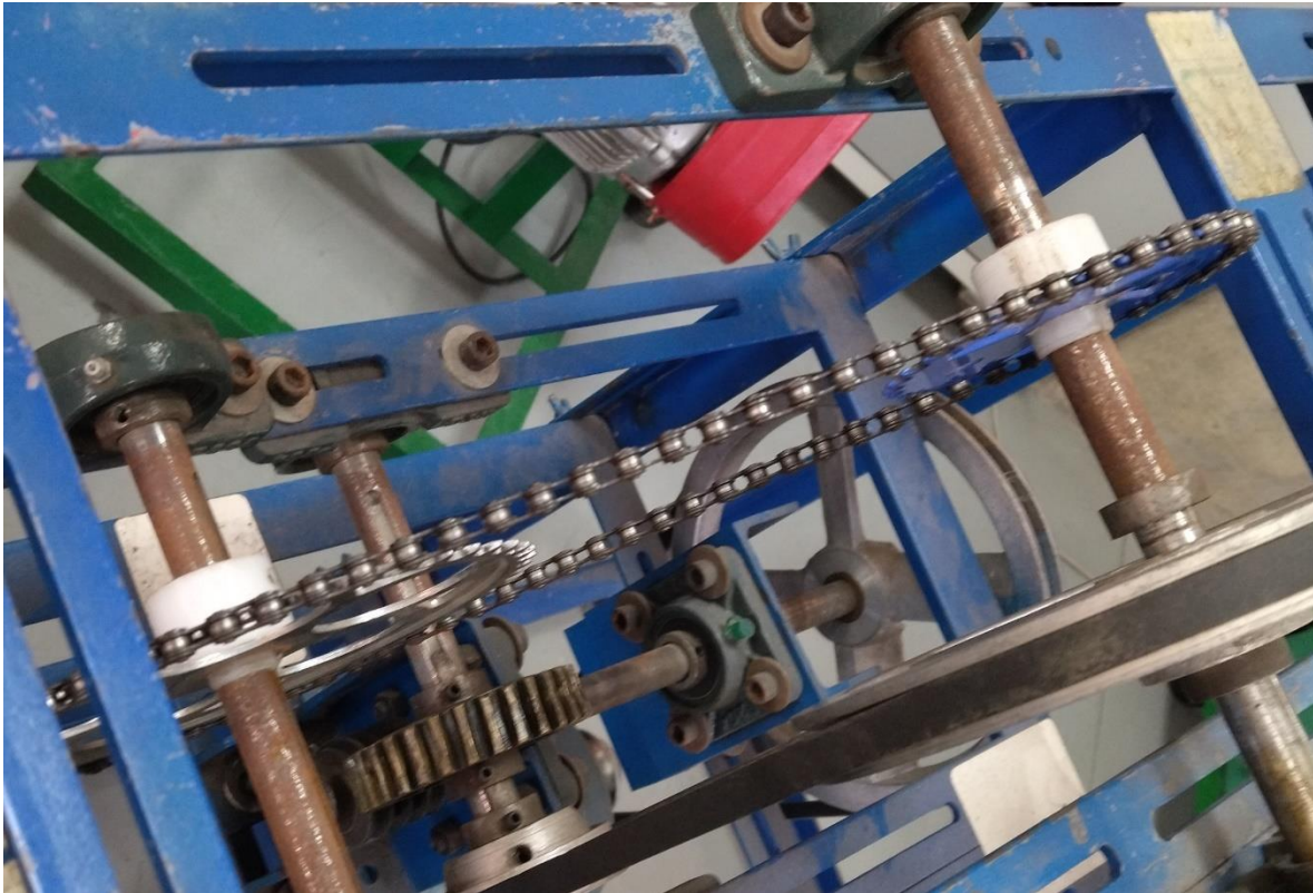
Figura 18. Sistema de transmisión por cadena antiguo, este sistema debe mejorarse a un sistema más robusto e industrial.
