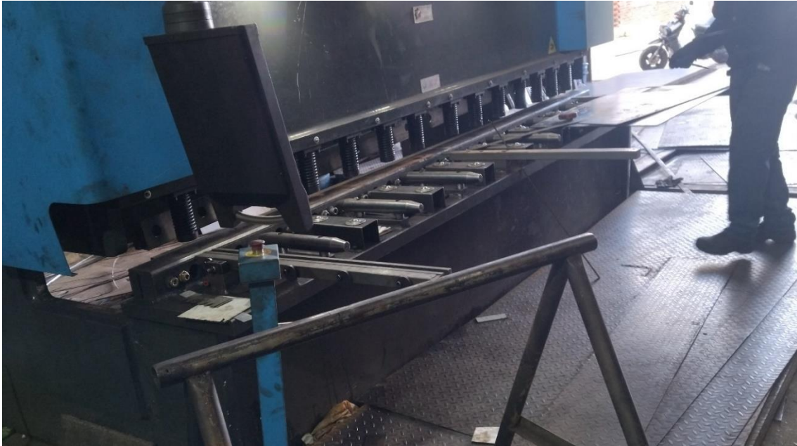
Figura 12. Máquina empleada para el corte de lámina de acero A36.
