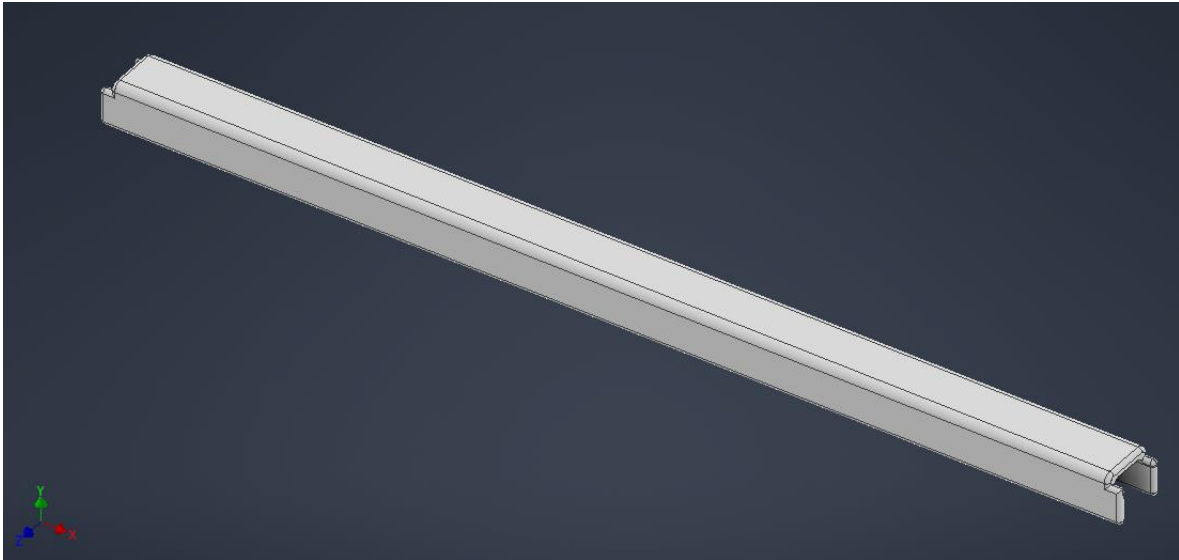
Figura 24. Diseño CAD de la silla para la elevación de la cremallera, esta silla se posiciona sobre el soporte de la cremallera.
