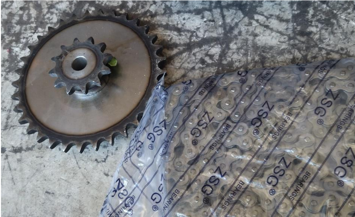
Figura 19. Sistema de Piñón – Cadena Nuevo, este sistema es más robusto que el sistema que poseía la máquina.
