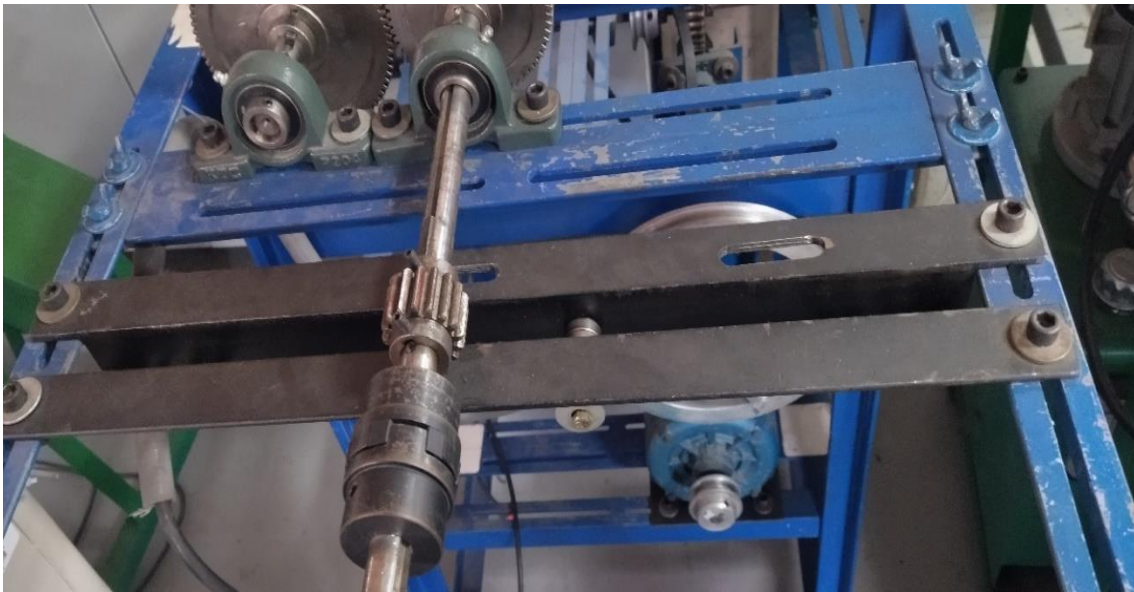
Figura 15. Sistema sin cuña en la etapa 5 de la máquina.
