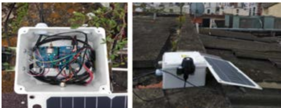
Figura 24. Nodo - Dispositivo de medición USTA-CUC
