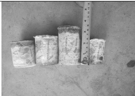
Figura 18: Núcleos extraídos. Fuente: Los autores
