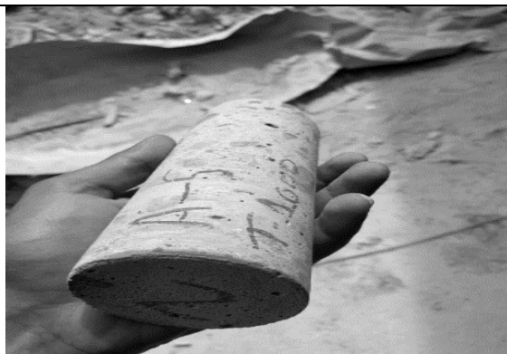
Figura 20: Testigo extraído. Fuente: Los autores
