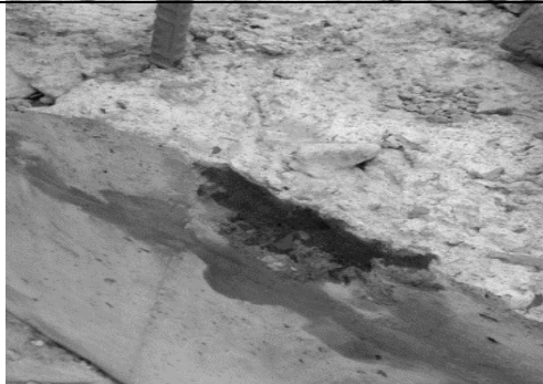
Figura 30: Procedimiento de roció de la fenolftaleína. Fuente: Los autores
