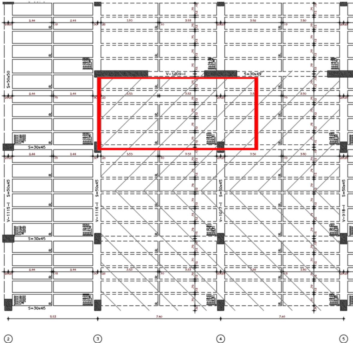
Figura 39: Zona donde fue necesaria la escarificación de la placa. Fuente: Autores.
