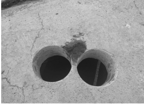
Figura 27: Escarificación previa al roció de fenolftaleína. Fuente: Los autores
