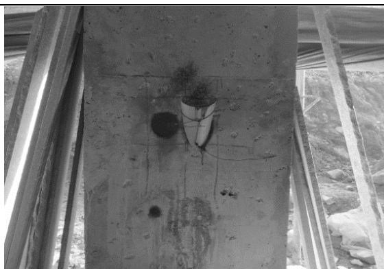
Figura 22: Procedimiento de extracción. Fuente: Los autores
