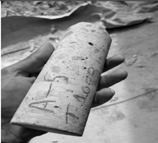
Figura 26: Núcleo extraído del edificio Club House. Fuente: Los autores
