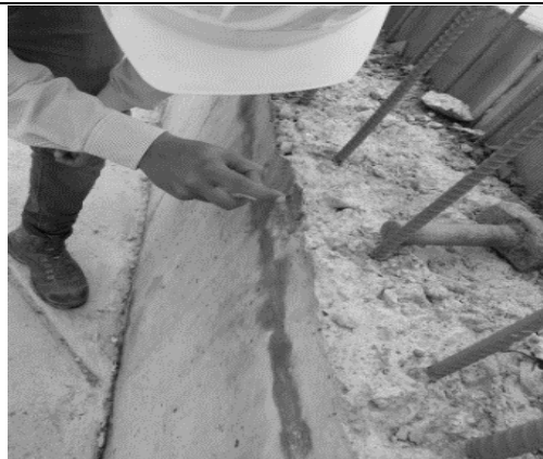
Figura 32: Ensayo de carbonatación. Fuente: Los autores
