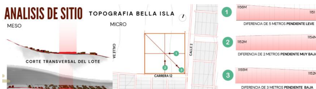
Figura 14. Topografía en lote
