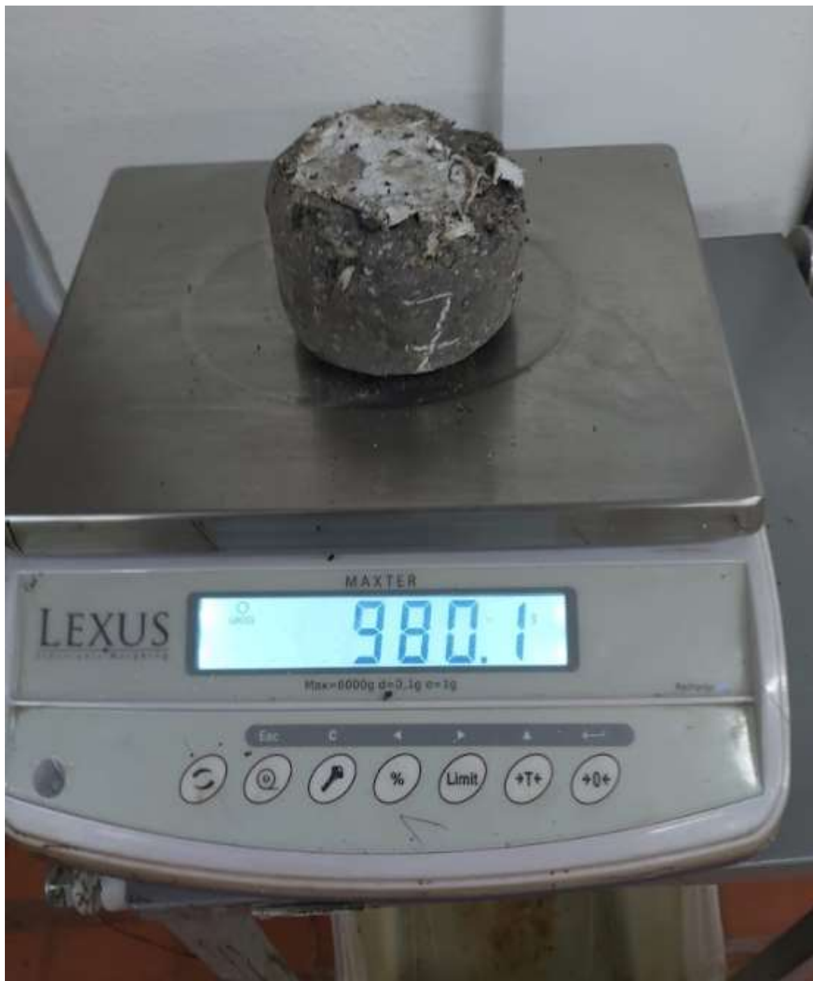
Anexo 36. Probeta No. 7, resultado final ensayo cántabro 1.0% cal – 2.0% cemento
