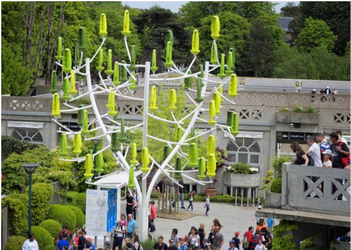
Figura 10. Aerogenerador Wind Tree.
