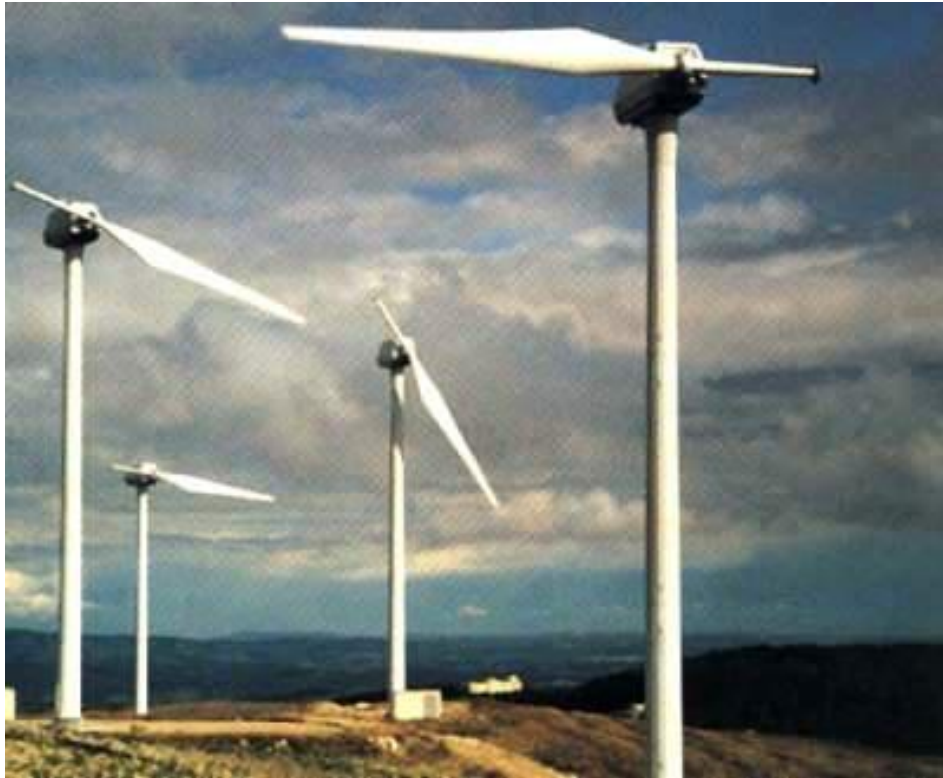
Figura 8. Aerogenerador tipo monopala.
