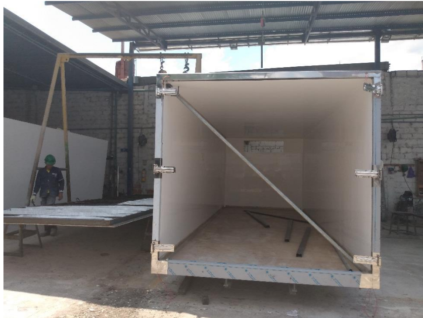
Figura 37. Ensamble y fabricación de furgones.
