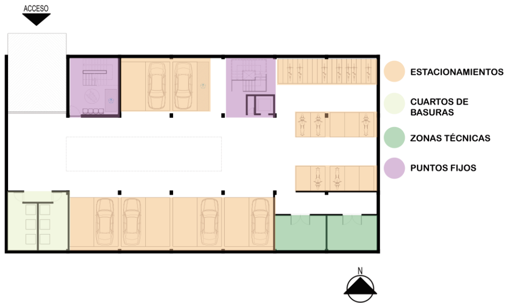
Figura 49. Zonificación de la planta de sótanos
