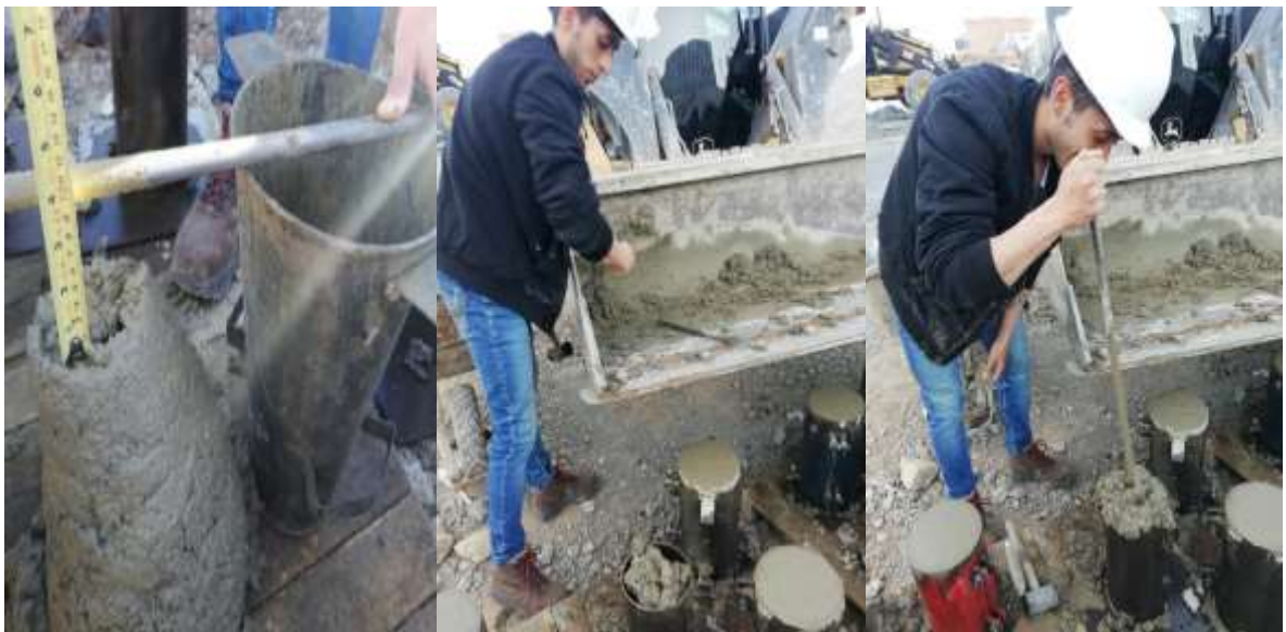
ILUSTRACIÓN 18 ELABORACIÓN MUESTRAS DE CONCRETO Y ENSAYO DE ASENTAMIENTO (SLUMP) Fuente: Autor
