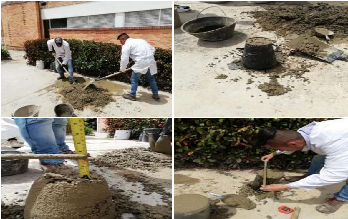
ILUSTRACIÓN 27 REALIZACIÓN MUESTRAS DE DISEÑO DE MEZCLA
