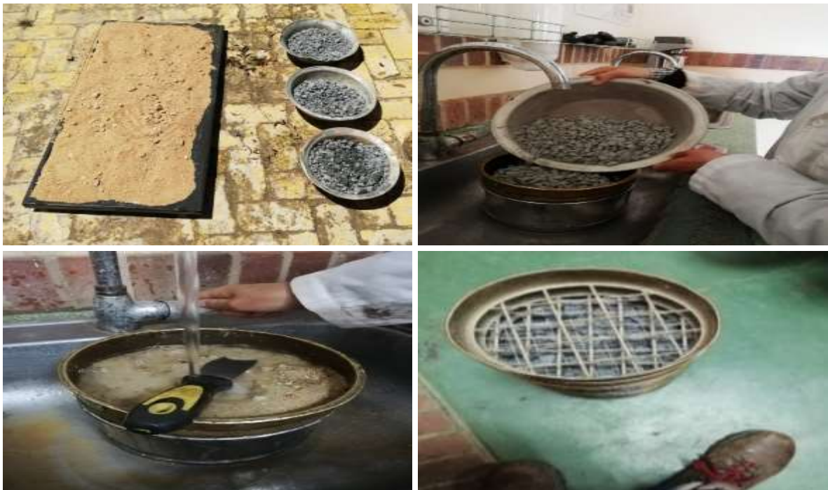
ILUSTRACIÓN 20 ENSAYO DE GRANULOMETRÍA POR MÉTODO TAMIZADO MECÁNICO
