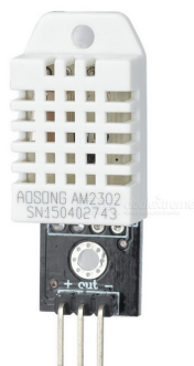
FIGURA 6: Sensor humedad y temperatura [32]
