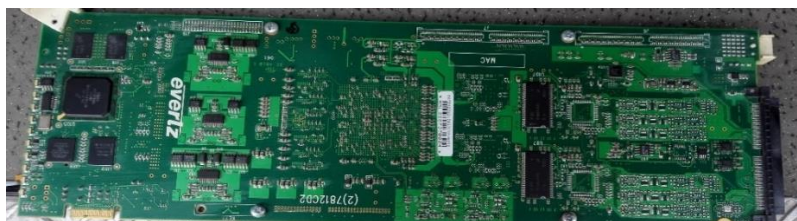
Figura 8. Tarjeta de la CCU de la móvil SD, presentaba fallas de sincronización.
