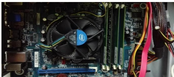
Figura 9. Desktop Boards de Intel presentaba tres pitidos al encender la CPU y no arrancaba, la falla que presentaba era la memoria RAM.
