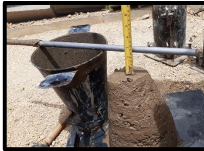
Ilustración 6. Ensayo de fluidez mediante cono
