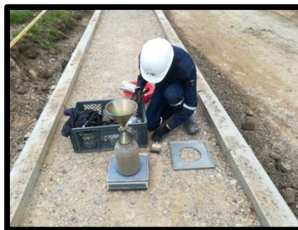
Ilustración 20. Toma de densidades para andenes tramo 3.
