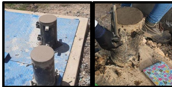
Ilustración 7. Toma de muestras de concreto pozo de inspección PP2 y PP1
