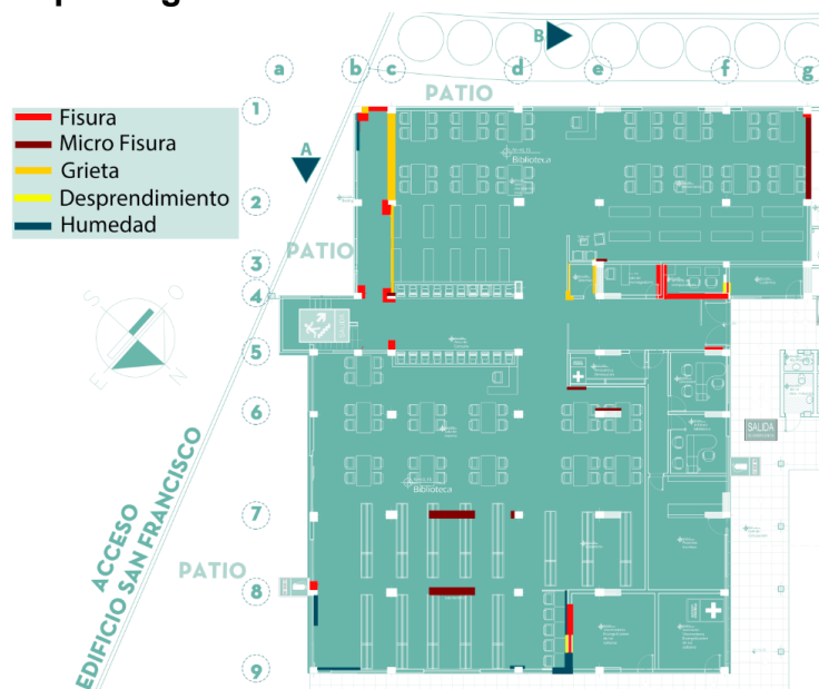
Ilustración 4, Plano de Localización de lesiones y patologías. Fuente: Los Autores
