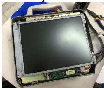
Figura 14. Cambio de pantalla monitor multiparámetros
