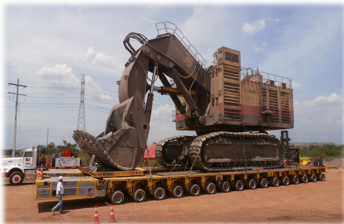
Ilustración 7: Equipo modular con carga de aproximadamente 800 toneladas
