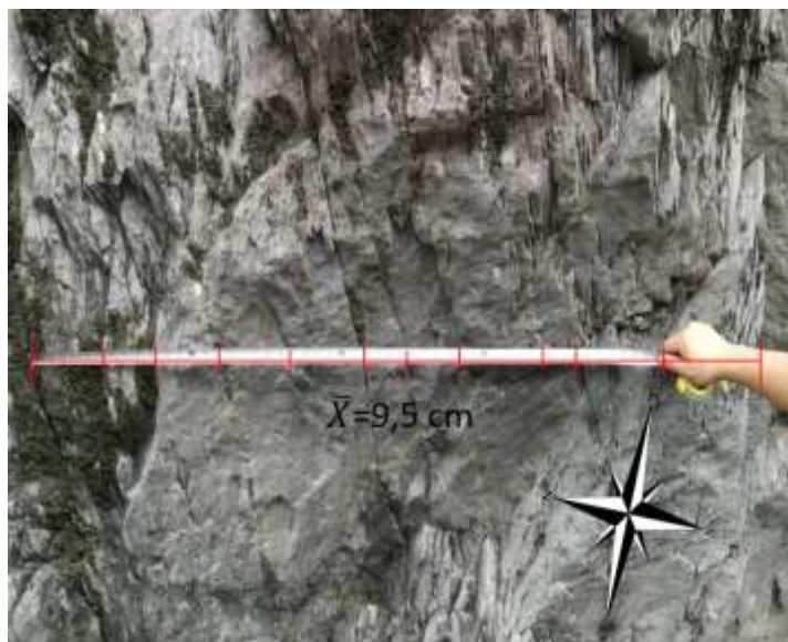
Figura 24. Fallas verticales del macizo rocoso del río Negro. Fuente: Propia.
