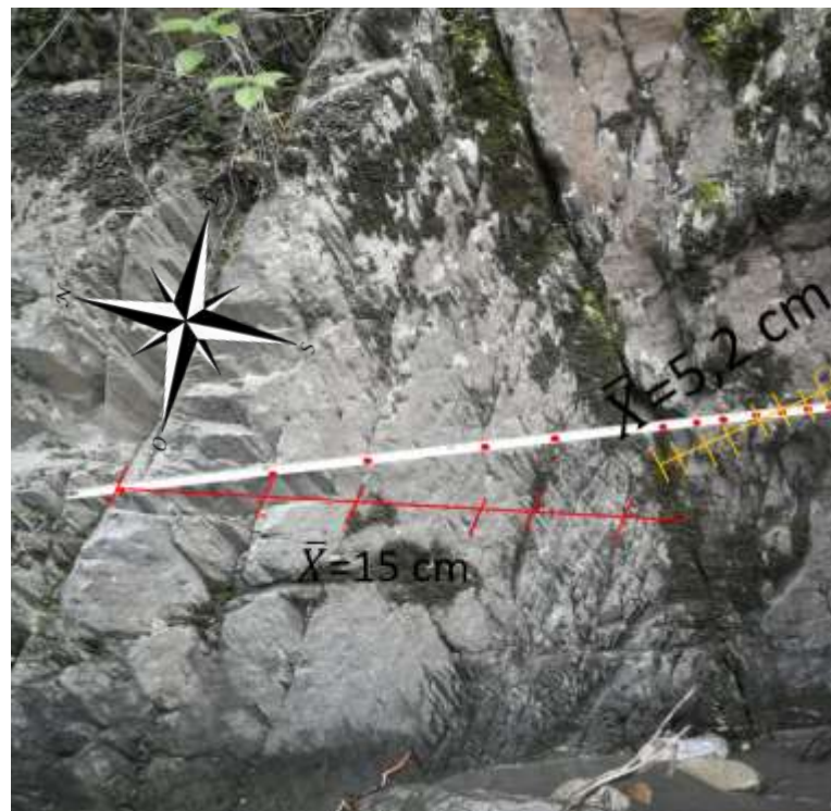
Figura 21. Dos tipos de familias verticales en el macizo rocoso del río Negro. Fuente: Propia.
