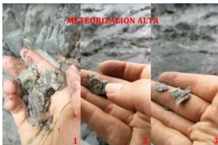
Figura 25. Nivel de meteorización del macizo rocoso del río Negro. Fuente: Propia.
