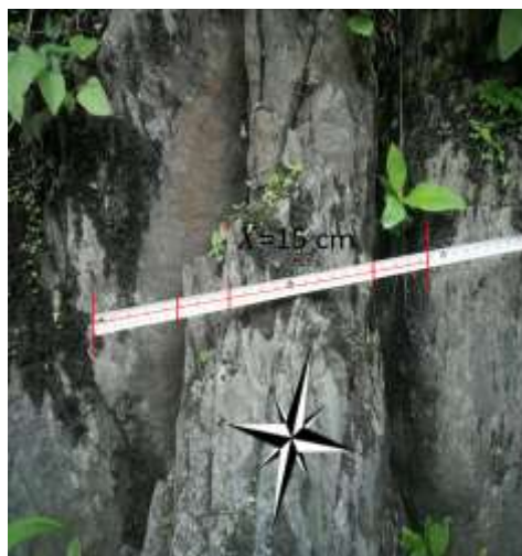
Figura 23. Fallas verticales del macizo rocoso del río Negro. Fuente: Propia.
