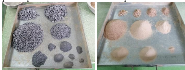
Fig. 13. Retención de tamices de grava y arena.
