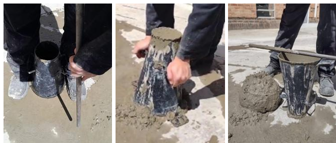
Fig. 7. Ensayo de asentamiento - Slump Fuente: Autores.
