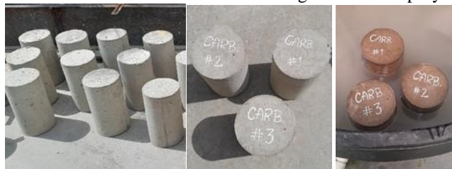
Fig. 9. Desencofrado y marcado de cilindros Fuente: Autores.
