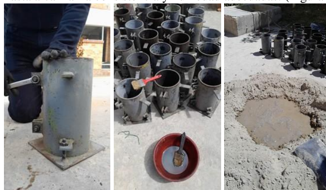
Fig. 5. Alistado y aplicación de desmoldante.
