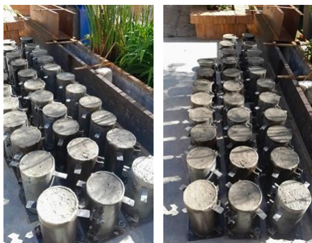
Fig. 8. Elaboración de cilindros. Fuente: Autores.
