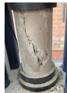
Fig. 22. Recolección de cilindros. Fig. 23. Falla de cilindros. Fuente: Autores.
