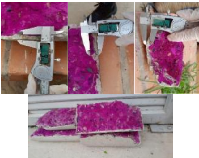
Fig. 25. Medición de profundidad de carbonatación. Fuente: Autores.
