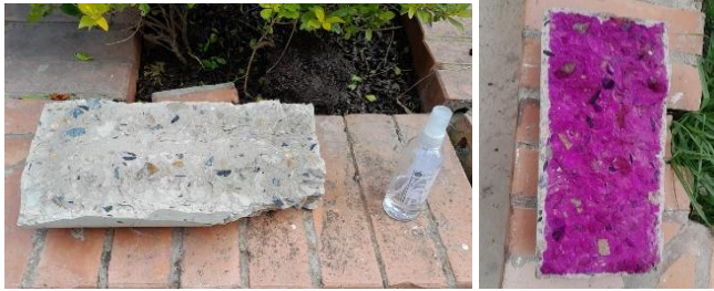
Fig. 24. Aplicación de indicador sobre falla. Fuente: Autores.
