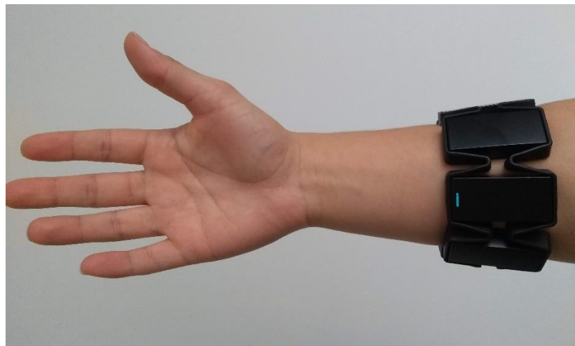
Figura 11. Ubicación adecuada del sensor Myo en el antebrazo. Tomado de: Autor.
