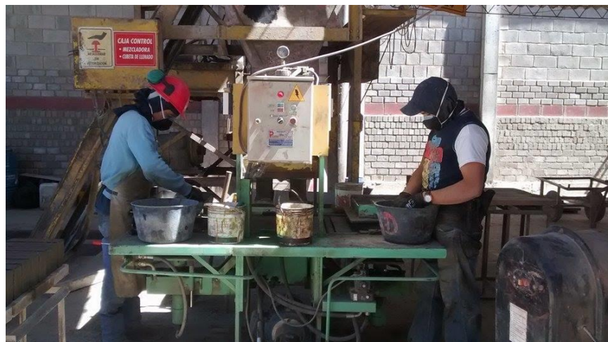
Figura 24 Proceso elaboración adoquines individualmente
