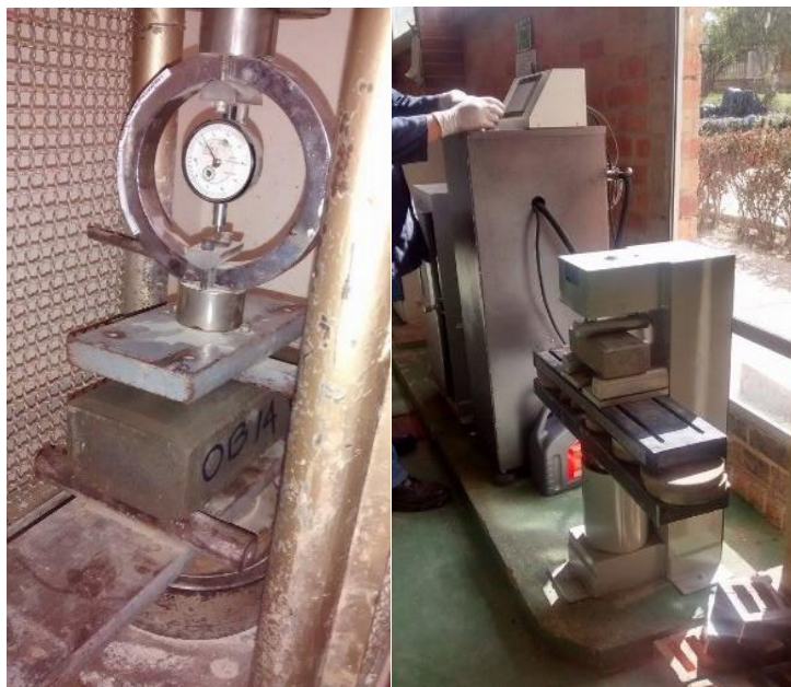
Figura 32 Máquina módulo de rotura (López Hermanos y USTA Tunja)
