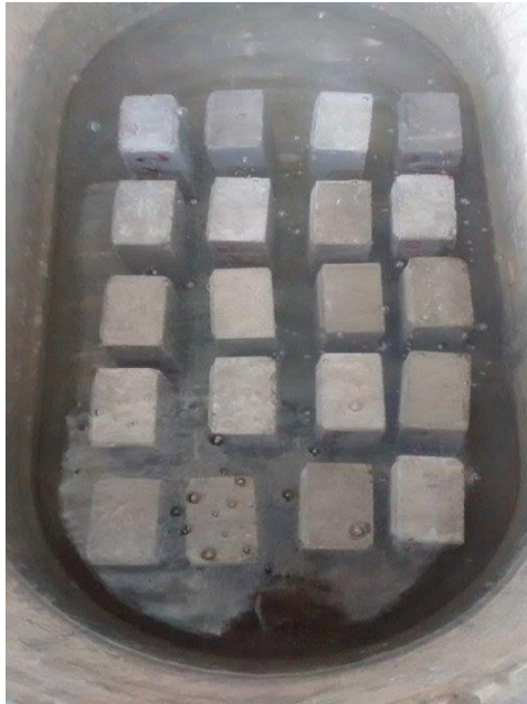
Figura 30 Adoquines sumergidos totalmente en agua
