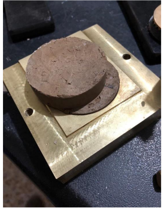
Ilustración 21. Muestras al finalizar ensayo de corte directo.
