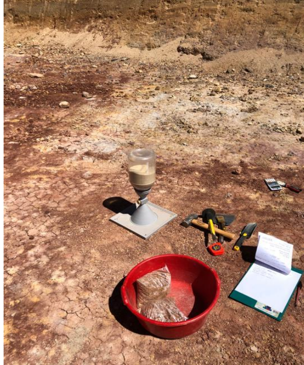
Ilustración 28. Ensayo método cono de arena.
