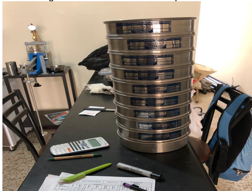
Ilustración 25. Análisis granulométrico de los suelos por tamizado.
