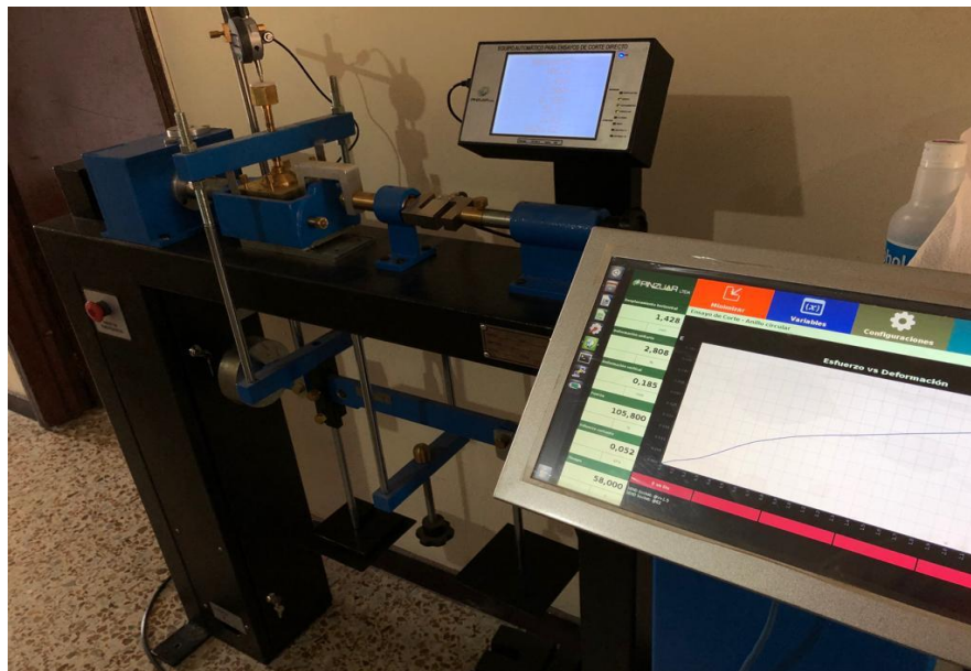
Ilustración 20 Corte directo en el equipo automático.
