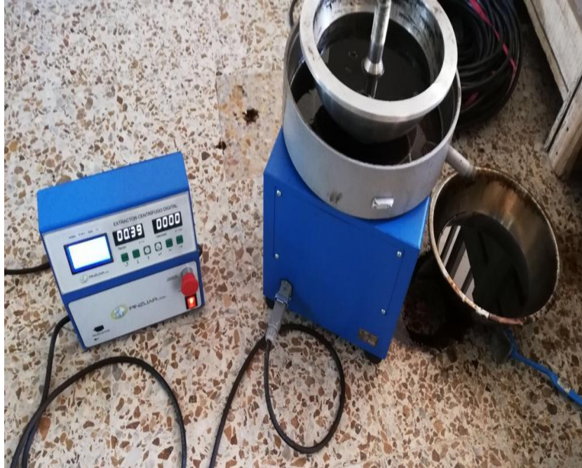
Ilustración 24. Extracción de asfalto en la maquina centrifuga digital.
