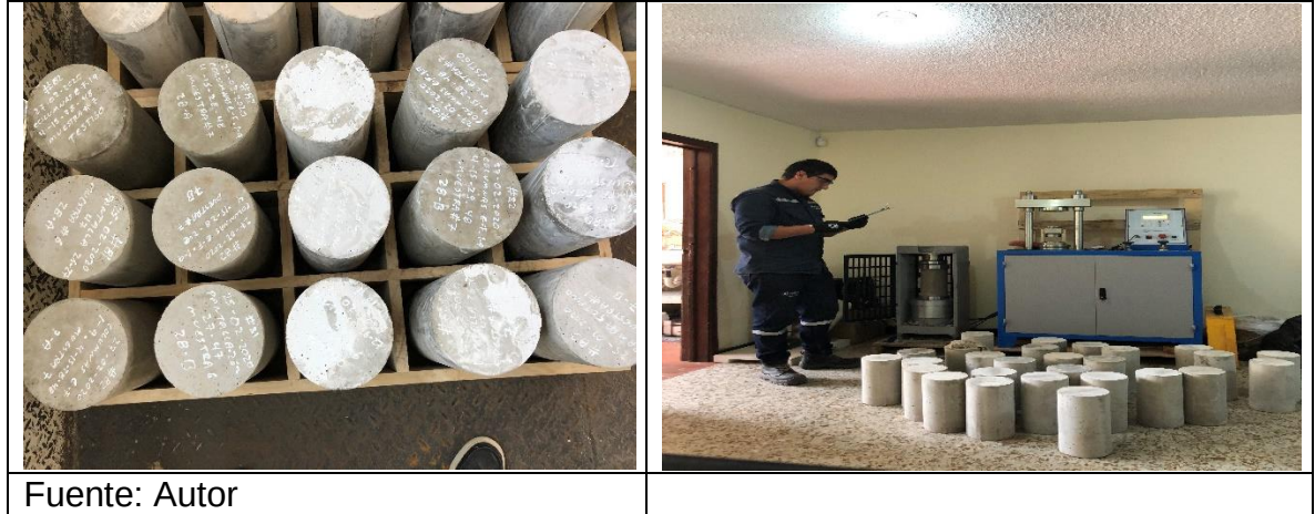
Ilustración 29 ensayos de la resistencia a la compresión de cilindros
