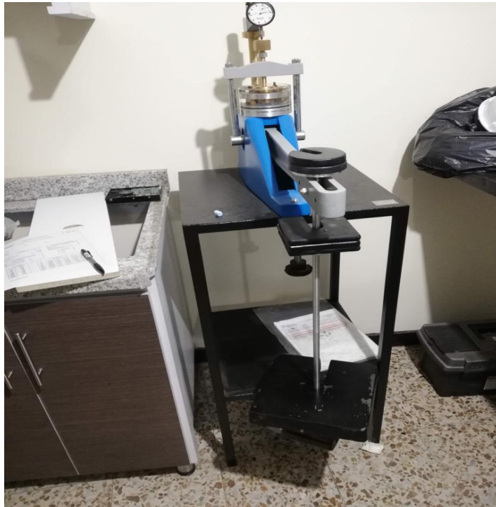
Ilustración 19. Aplicación carga para consolidar.
