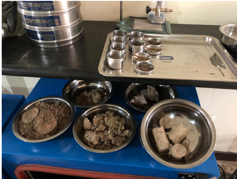
Ilustración 13. Determinación del contenido de humedad.
