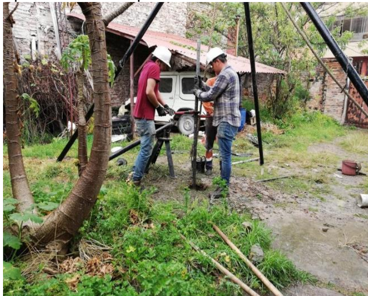
Ilustración 11. Exploración en campo finalizando la extracción.
