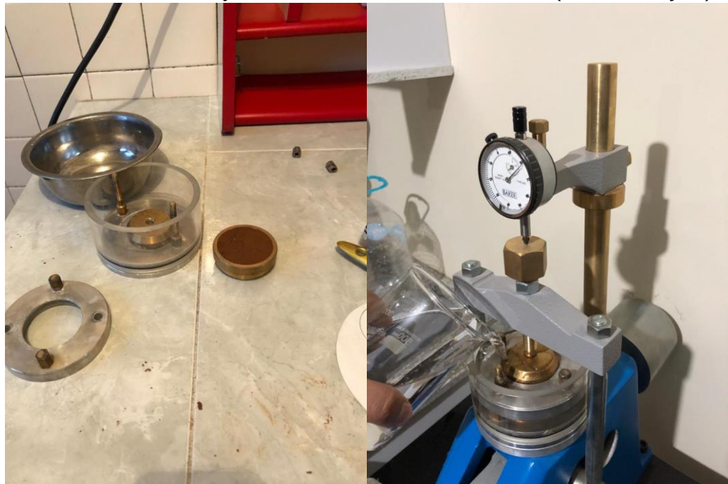
Ilustración 18. Montaje Consolidación unidimensional (Método Taylor).
