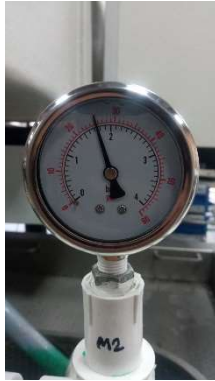
Ilustración 1. Manómetro de glicerina de 60 PSI
