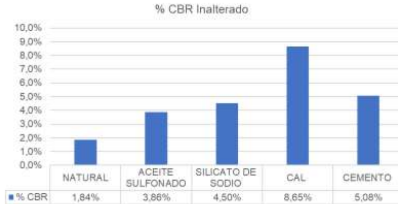
Gráf. 2. COMPARACIÓN DE LOS VALORES DE CBR INALTERADO PARA EL SUELO NATURAL Y ESTABILIZADO
