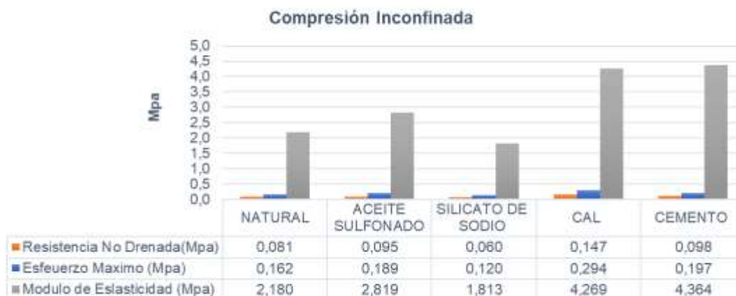
Gráf. 3. COMPARACIÓN DE LOS RESULTADOS OBTENIDOS EN EL ENSAYO DE COMPRESIÓN INCONFINADA PARA EL SUELO NATURAL Y ESTABILIZADO
