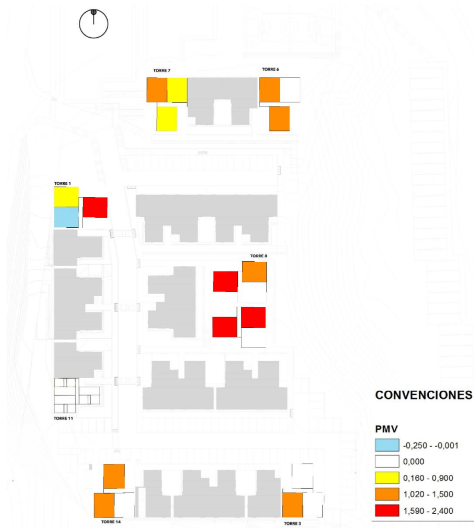
Ilustración 18 Voto medio estimado (PMV), basado en las encuestas realizadas en sitio, segundo piso, 2015. Fuente elaboración propia.
