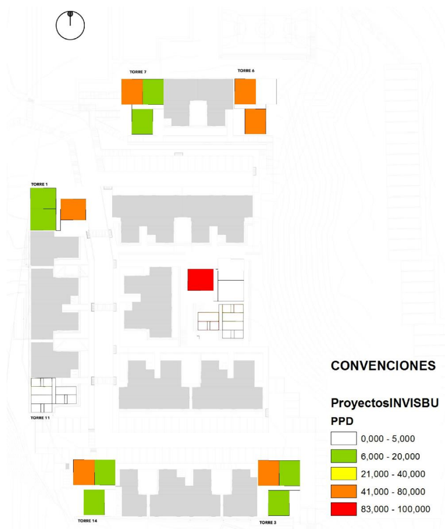
Ilustración 21 Porcentaje de personas insatisfechas (PPD), basado en las encuestas realizadas en sitio, segundo piso, 2015. Fuente elaboración propia.
